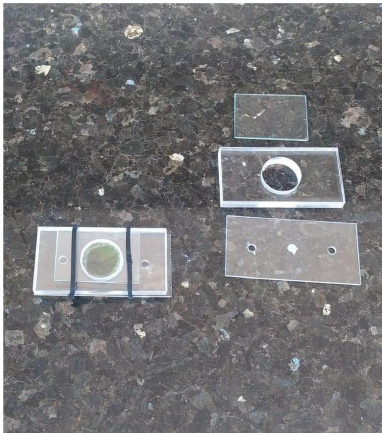
Figura 43: Placas Münger empleadas para el ensayo. Elaboración propia
