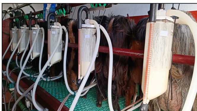
Imagen 29. Medidores volumétricos instalados en cada punto de ordeño. Fuente: elaboración propia.
