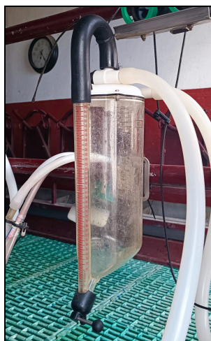
Imagen 20. Medidor nacional volumétrico cónicos OV/CB de 3,5 litros. Fuente: elaboración propia.
