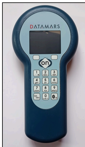
Imagen 21. Lector DATAMARS GES3S EU. Fuente: elaboración propia.
