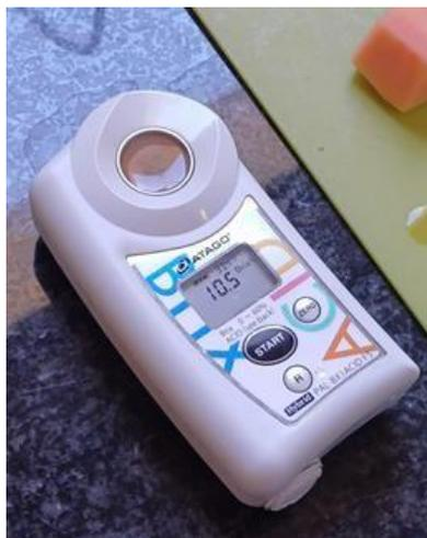
**Foto 13:** Refractómetro digital de mano ATAGO (modelo PAL-BXACID F5).
