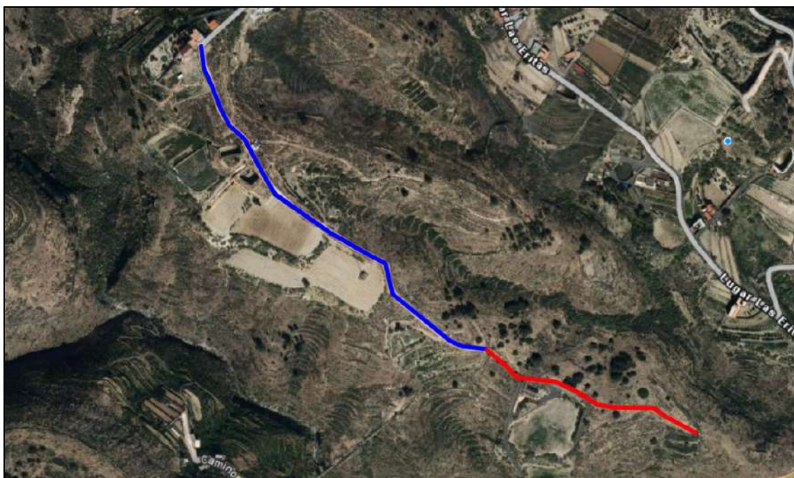
Imagen 1. Trazado del Camino Transversal Las Eritas: tramo existente de pista de tierra (azul); tramo a ampliar (rojo) (Fuente: cartografía adaptada de GRAFCAN 1 ).
