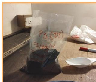
**Foto 13 y 14.** Demostración del tamizado de las muestras y su posterior embolsado con identificación correspondiente.
