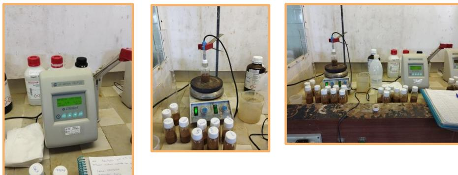
Foto 19, 20 y 21. pH-metro y detalle de la medida de pH
