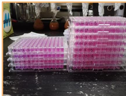
**Foto 25 y 26.** Baño maría de agar/indicador (150 ml) e imagen de la disolución dispensada en las placas de detección.
