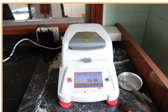
**Foto 18.** Analizador de humedad modelo MB120, marca OHAUS.
