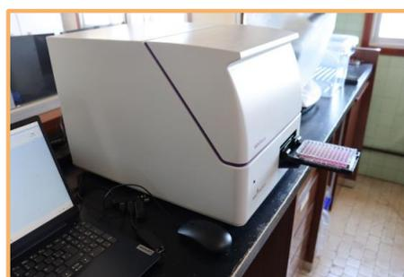
**Foto 31 y 32.** Sistema de abrazaderas instalado para esperar a la actuación del agua y las fuentes de carbono añadidos y foto del espectrofotómetro utilizado para la obtención de datos de capacidad de 572 nm de longitud de onda.
