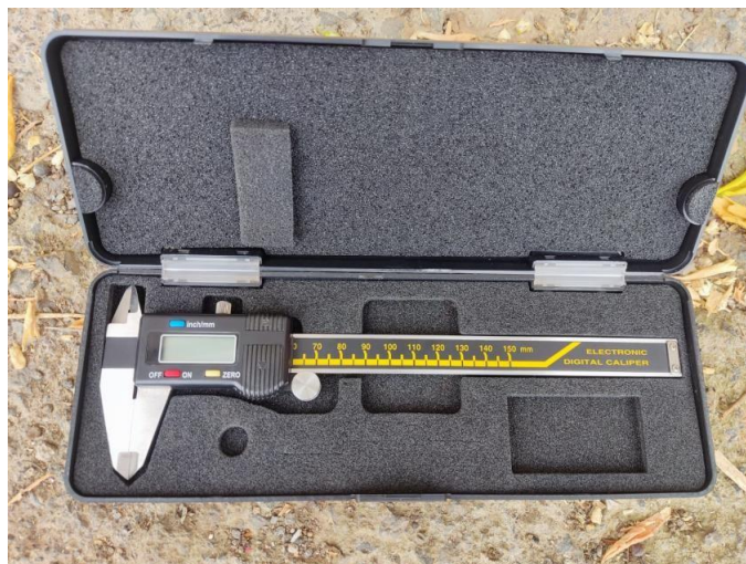
Figura 18. Pie de rey utilizado para las mediciones.
