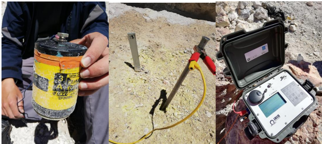
Figura 2: De izquierda a derecha se muestran: equipo básico Electrodo, barra de metal con cable y Milivoltímetro. Elaboración propia
