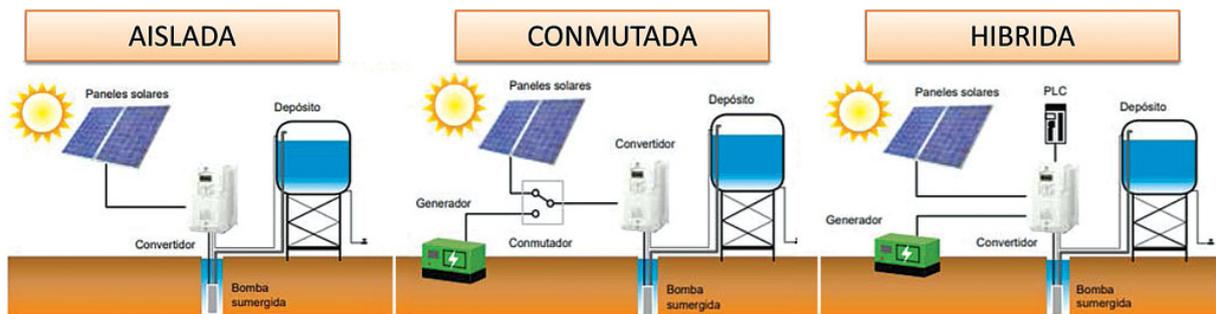
**Figure 19:** Representación de los sistemas de bombeo solar posibles dependiendo de la fuente de alimentación, en donde se distinguen tres tipos: aislada, conmutada e híbrida. Imagen extraída de [18].
