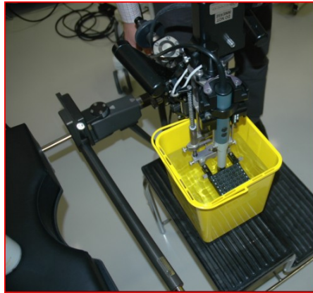
Montaje para realizar la calibración de la rejilla del ecógrafo.
