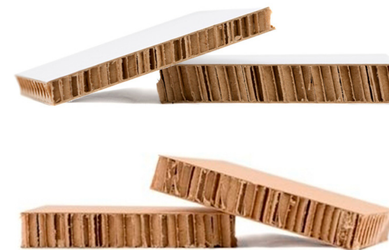
Fig 71. Nido de abeja acabado kraft y acabado caras blancas para impresión. Web: https://moldiber.com/blog/que-es-el-carton-nido-de-abeja/
