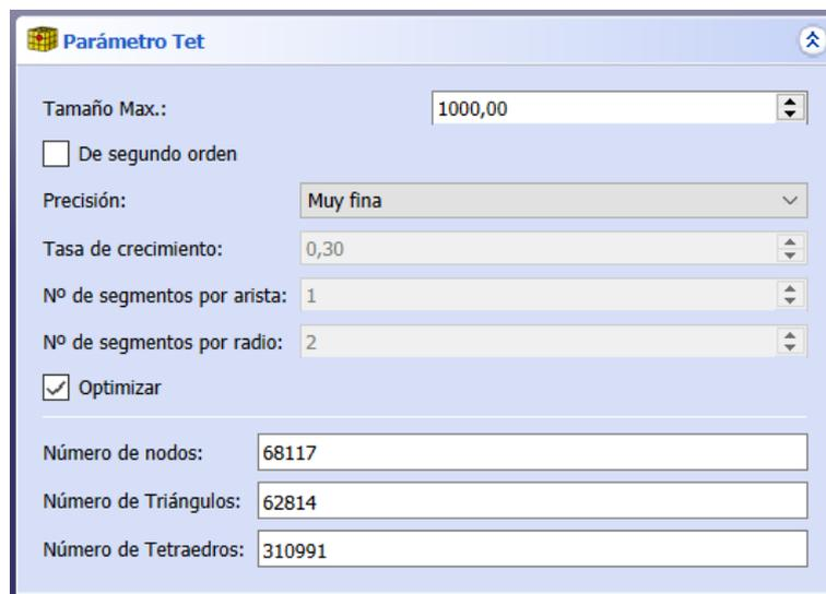
**Figura 3.10:** Elementos y parámetros de la malla del análisis por Netgen.
