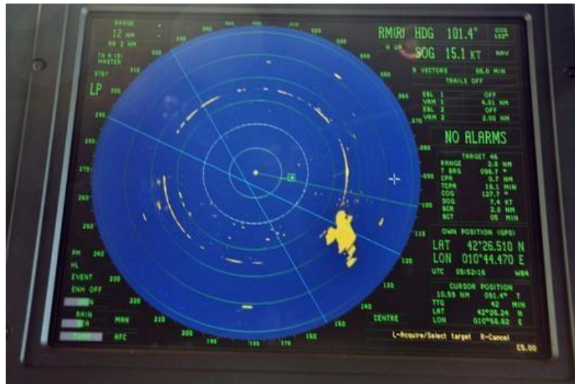
Ilustración 10: Radar banda S detectando blancos. Fuente: www.navegar.com
