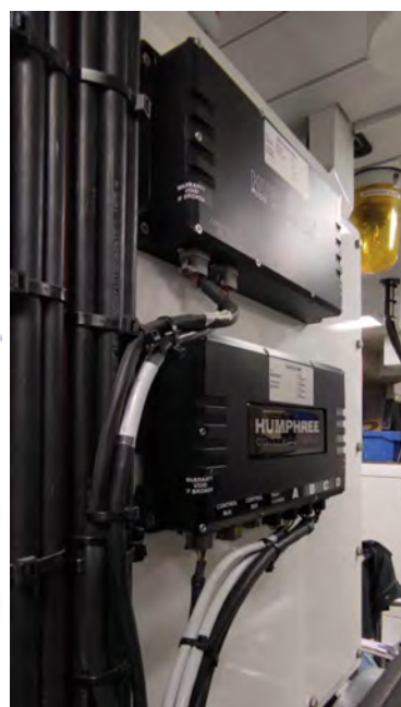
Figura 33: Conexión unidad de control maestra (Fuente: Trabajo de campo)
