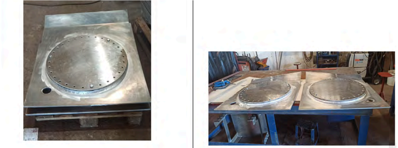
Figura 15: Plancha estabilizador del casco (Fuente: Trabajo de campo)
