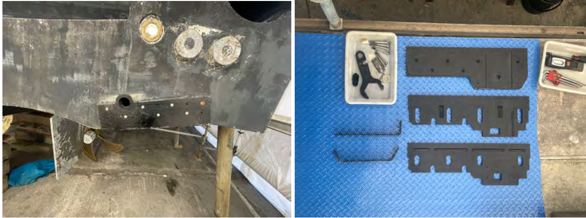
Figura 1: Interceptores (Fuente: Trabajo de campo)
