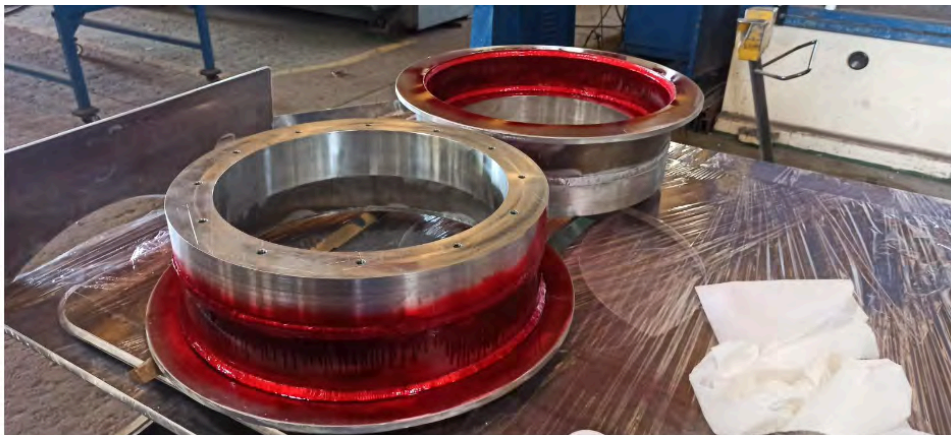
Figura 16: Aros de refuerzo (Fuente: Trabajo de campo)
