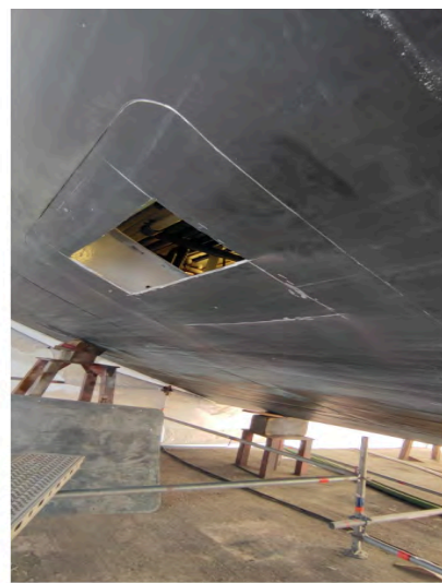
Figura 14: Corte casco (Fuente: Trabajo de campo)
