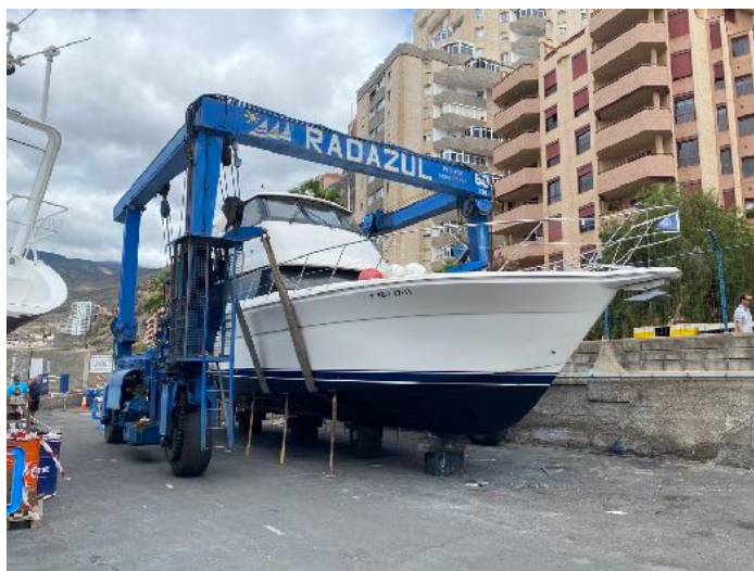
Ilustración 4. Barco apuntalado para posterior mantenimiento. Fuente: Elaboración propia.
