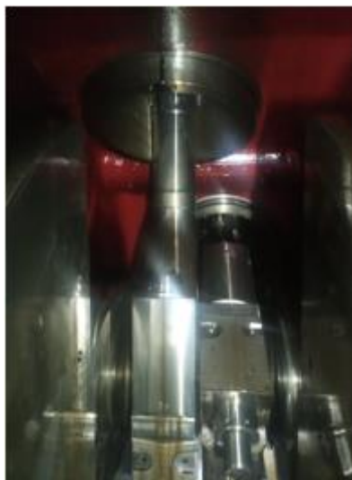
Ilustración 55. Tren alternativo observado desde la tapa del cárter de dicha unidad de potencia. Fuente: Elaboración propia.
