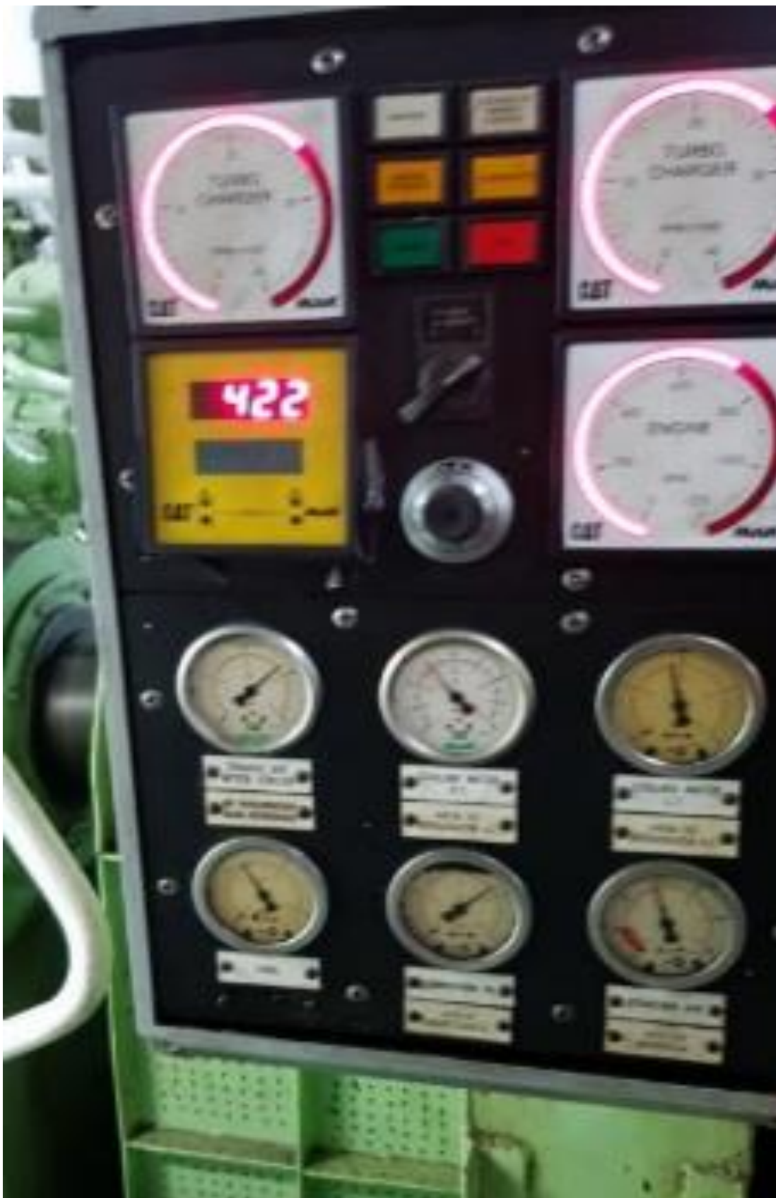
Ilustración 63. Cuadro de parámetros del motor principal en la sala de máquinas (tecle inferior). Fuente: Elaboración propia.
