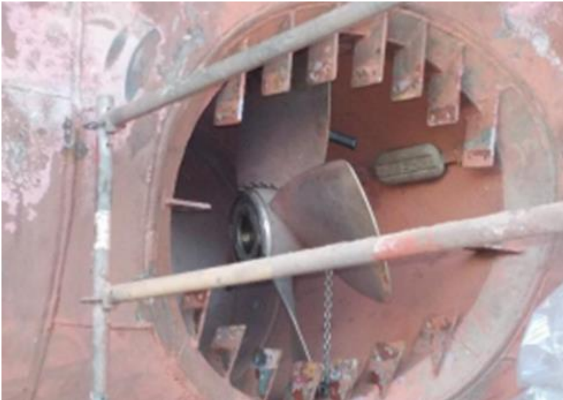
Ilustración 2. Hélice de proa en varada. Fuente: Documentación de abordó.
