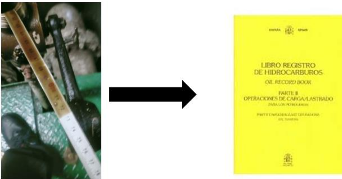
Ilustración 44. Imagen de sonda del tanque de lodos y del libro de hidrocarburos del buque. Fuente: Elaboración propia.
