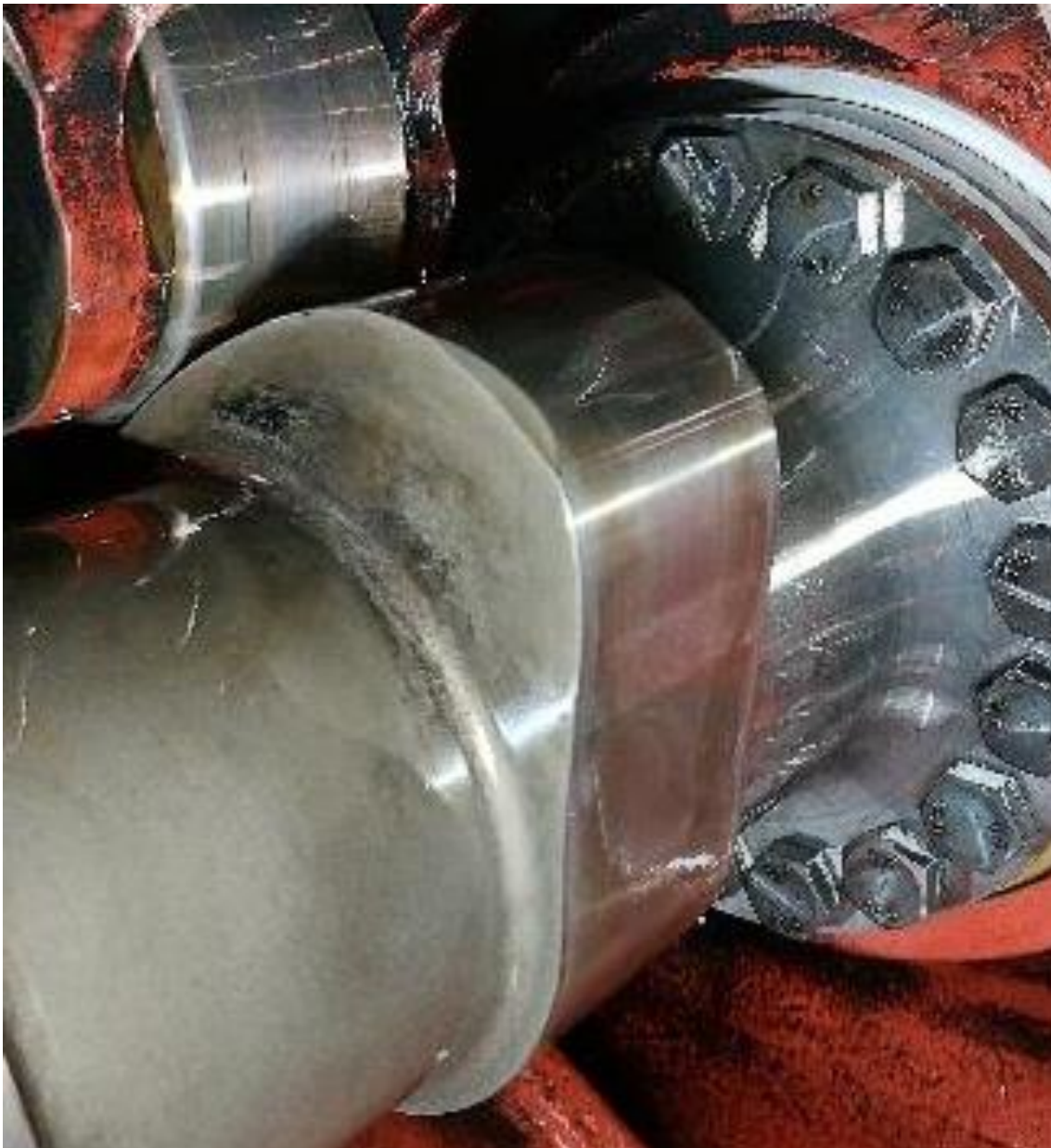
Ilustración 57. Sección del árbol de levas con el taqué correspondiente a la leva. Fuente: Elaboración propia.
