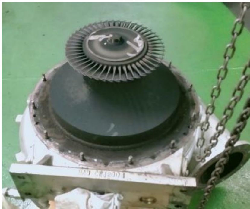
Ilustración 61. Turbina de gases del turbocompresor de babor. Fuente: Elaboración propia.
