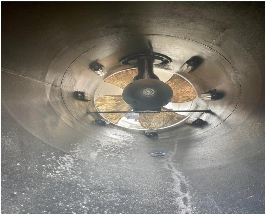
*Ilustración 12. Hélice de proa de paso variable. Fuente elaboración propia*
