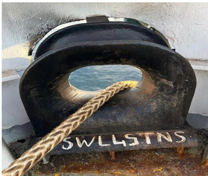
*Ilustración 7. Cabo a través de Gatera. Fuente: Elaboración propia.*
