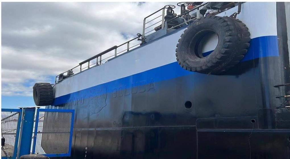
*Ilustración 4. Defensas de neumático reciclado. Fuente: Elaboración propia*
