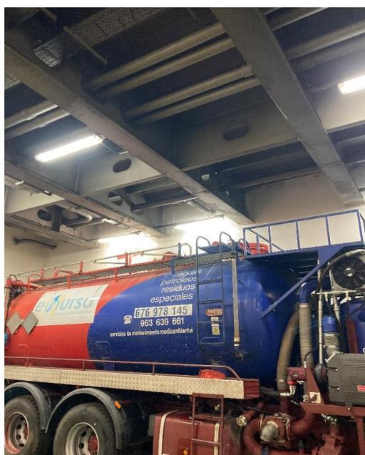
**Ilustración 17.** Retirada de las aguas residuales del buque mediante los medios de tierra (Camión Cisterna).
