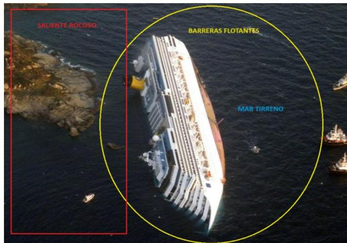
**Ilustración 12.** Vista de alzado del naufragio con la barrera flotante para evitar el vertido de combustible.
