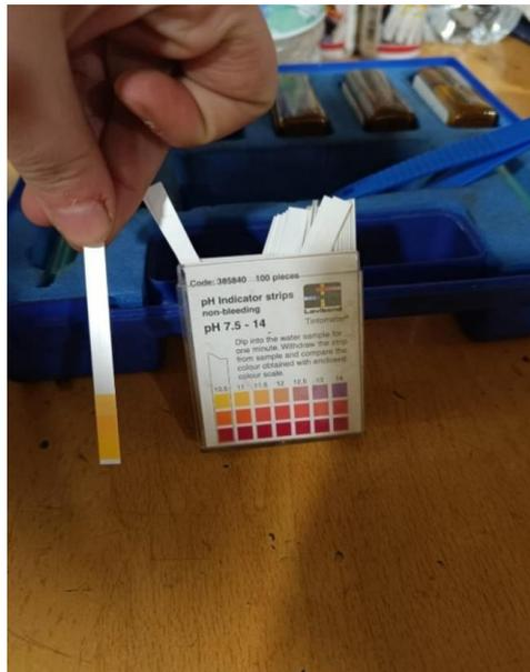
**Ilustración 22.** Pruebas del pH del efluente.
