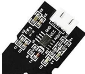
Figura 35: Preamplificador sensor humedad sustrato
