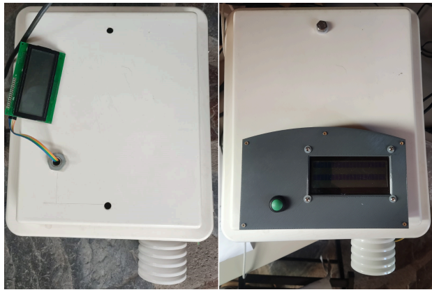
Figura 22: Caja Sistema Central con display LCD
