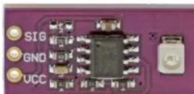
Figura 37: Preamplificador sensor UV
