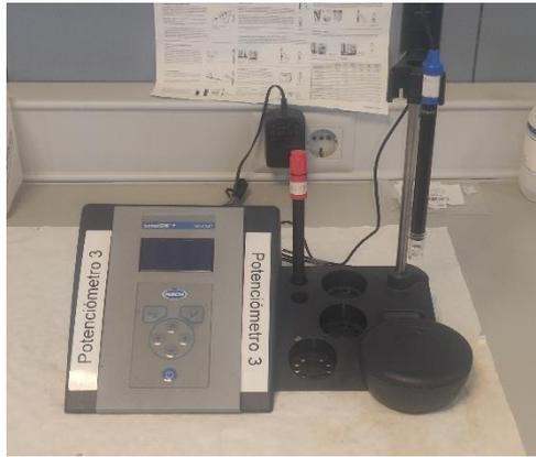
Figura 2. Potenciómetro y electrodo selectivo de iones fluoruro (ISE)
