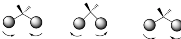
Figura 3.17_Vibración de flexión asimétrica dentro del plano (scissoring) 39
