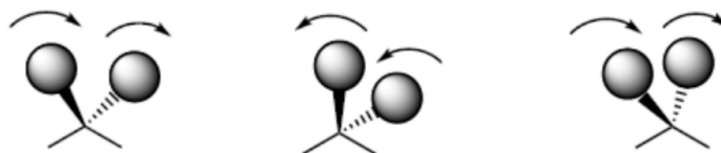
Figura 3.20-Vibración de flexión simétrica fuera del plano (wagging) 39
