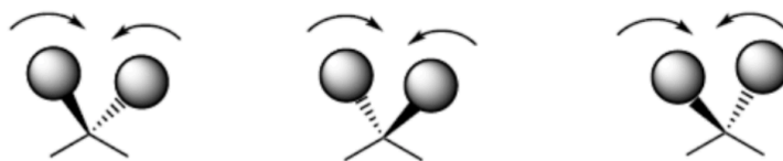
Figura 3.19-Vibración de flexión asimétrica fuera del plano (twisting) 39
