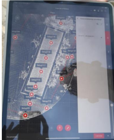
Figura 19: Fotografía de la Tablet a través de la cual se gestionaba el inicio y alineación de los escaneados con Cyclone Field 360 (elaboración propia, 29/02/24)
