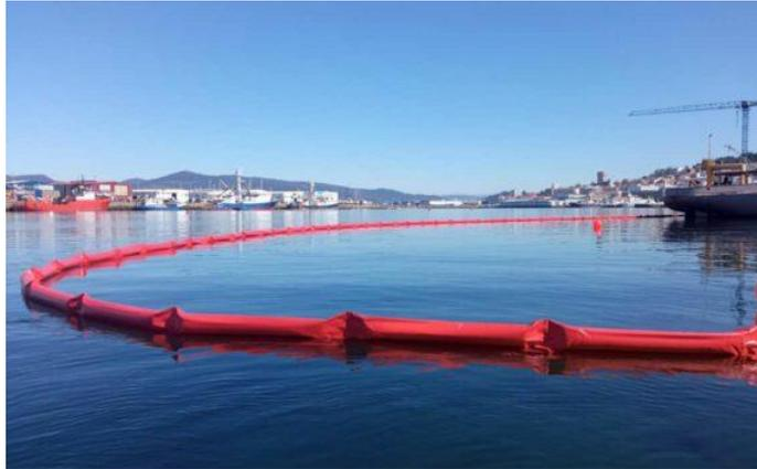
**Ilustración 30.** Barrera de contención desplegada.
