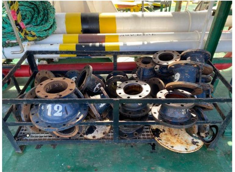
**Ilustración 6.** Caja de reducciones para conexiones mangueras – colector. Buque Petromar. Fuente: trabajo de campo.
