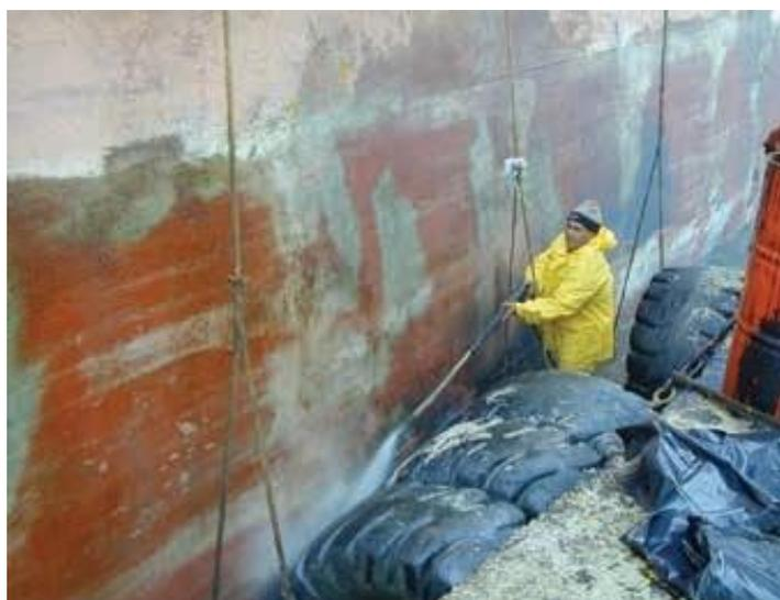
*Ilustración 22. Limpieza de cascos. Efectos en los puertos. Fuente: ITPF.com*
