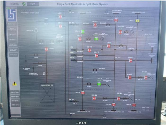
**Ilustración 12.** Ordenador alineación válvulas buque Petromar. Cubierta principal. Fuente: trabajo de campo
