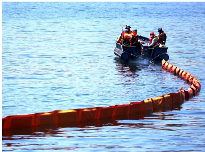
*Ilustración 40. Despliegue barrera de contención. Fuente: absorbentesdehidrocarburos.com*
