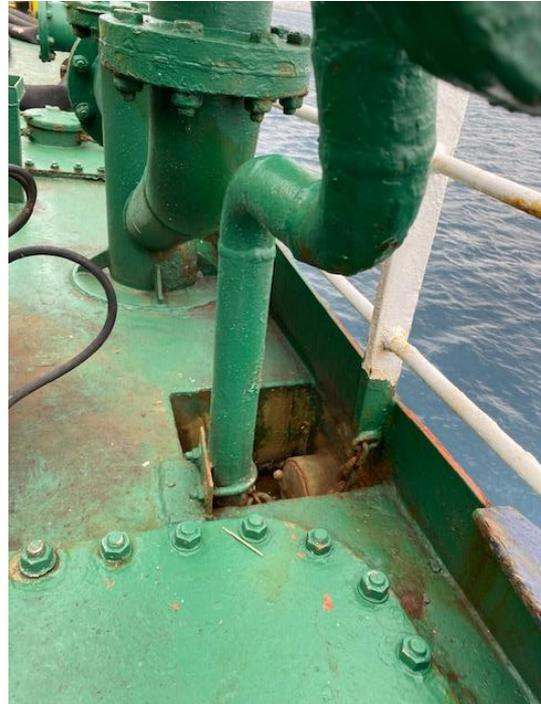
**Ilustración 31.** Pocete aspiración vertido en cubierta.
