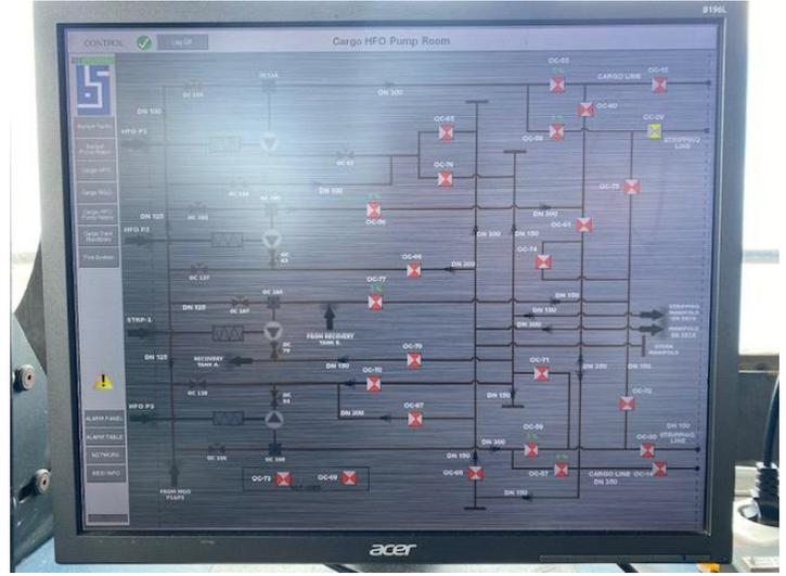
**Ilustración 11.** Ordenador alineación válvulas buque Petromar. Cámara de bombas. Fuente: trabajo de campo
