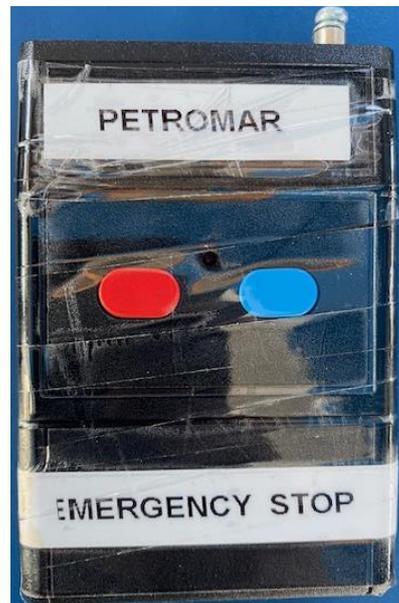
*Ilustración 24. Para de emergencia de bombas remoto. Fuente: trabajo de campo.*
