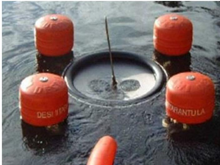
*Ilustración 41. Skimmer. Recogida hidrocarburo.
