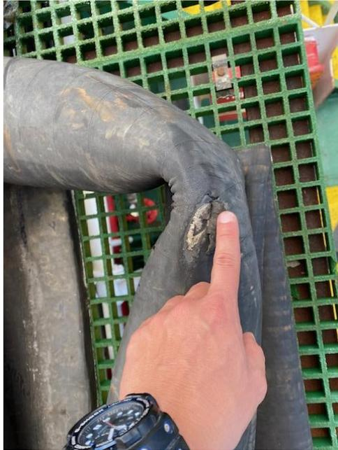
*Ilustración 5. Manguera de suministro deteriorada. Fuente: trabajo de campo.*
