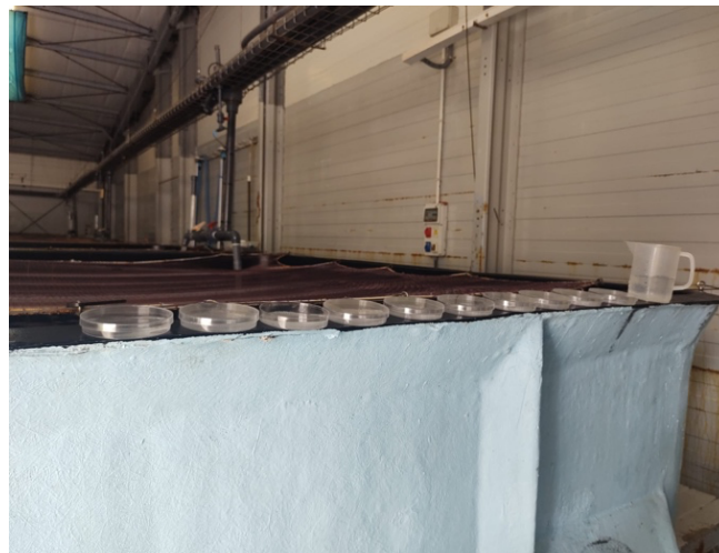
Figura 8. Preparación de las placas de Petri con agua de mar filtrada antes de la extracción de las mallas del tanque.
