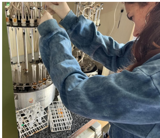
Figura 14. Evaporación del solvente mediante el vaporizador de nitrógeno.
