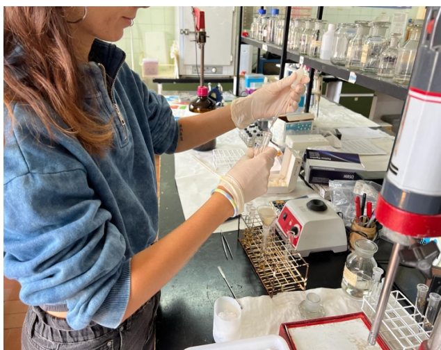
Figura 15. Extracción y transferencia de la fase superior de los tubos para la obtención de los FAMES.
