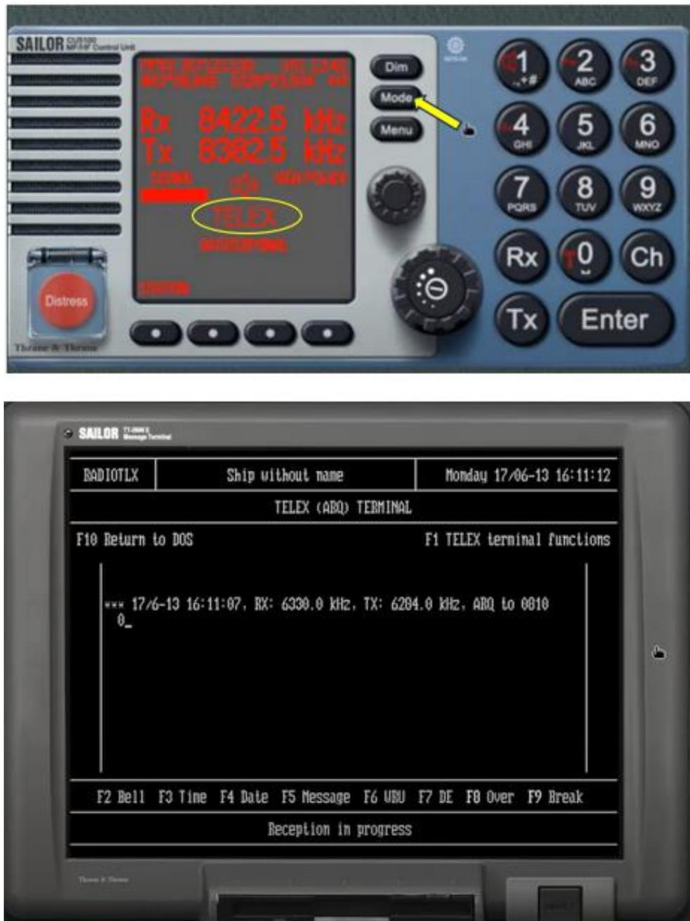
**Ilustración 152.** Radiotelex y equipo asociado MF/HF en modo télex.
