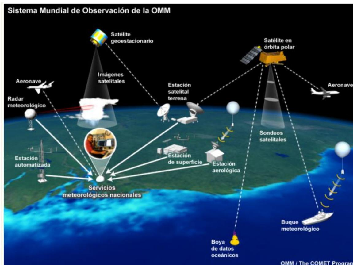
**Ilustración 136.** Medios que componen el Sistema Mundial de Observación de la OMM.
