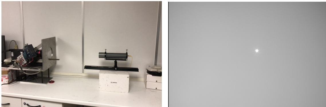
(a) Láser simulador de estrella junto a buscador QHYCCD 600 PRO en el laboratorio del IAC.
