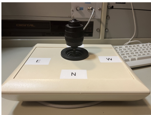
(a) Joystick para controlar los carros X-Y del sistema de auto-guiado del IAC80.
