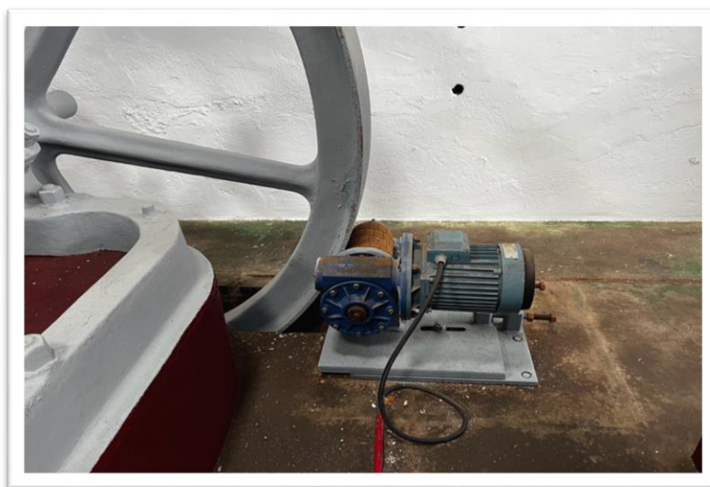
Ilustración 35: Motor eléctrico en el volante de inercia para máquina de vapor de 60 CV (Fondo documental de la Destilería de San Bartolomé de Tejina, S.A.).
