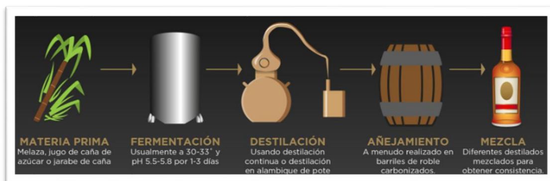
Ilustración 3: Proceso de obtención del ron (Vino Premier, 2020).
