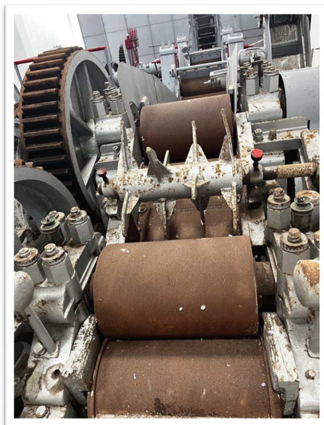
Ilustración 30: Cortadora y molinos trituradores (Fondo documental de la Destilería de San Bartolomé de Tejina, S.A.).
