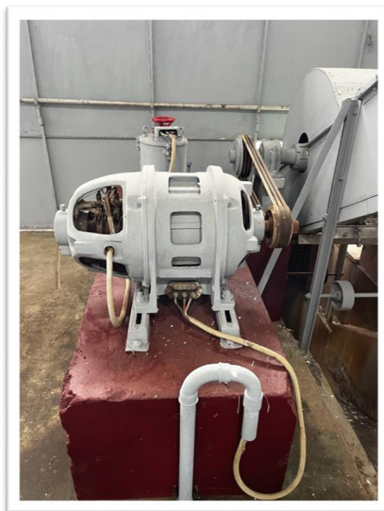
Ilustración 31: Motor para accionar la cinta transportadora (Fondo documental de la Destilería de San Bartolomé de Tejina, S.A.).
