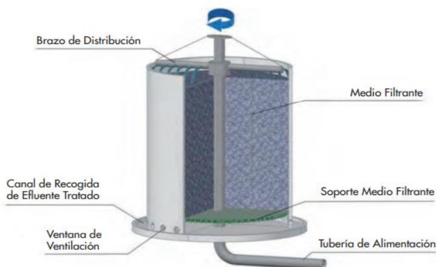
Ilustración 19. Esquema de un lecho bacteriano (CEDEX, 2010)
