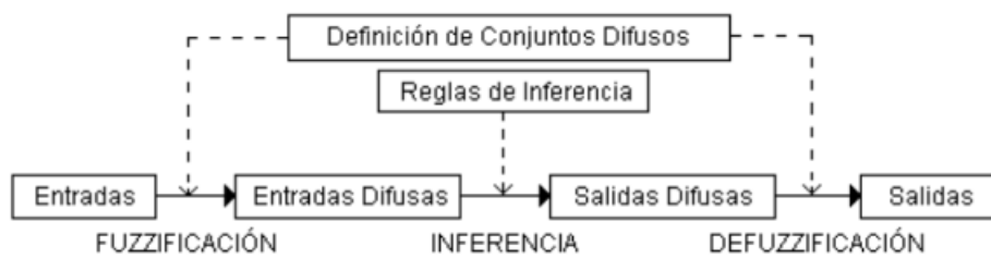
Ilustración 50: Esquema general de un controlador difuso [16]
