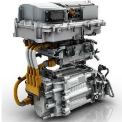
Ilustración 23: Motor síncrono Renault Zoe (65 KW). Fuente: Forococheseléctricos
