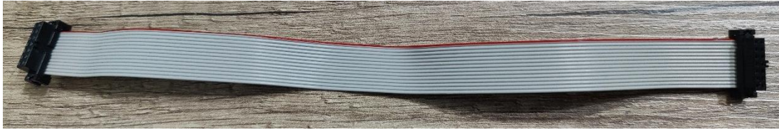
Ilustración 63: Cable flexor que comunica las placas
