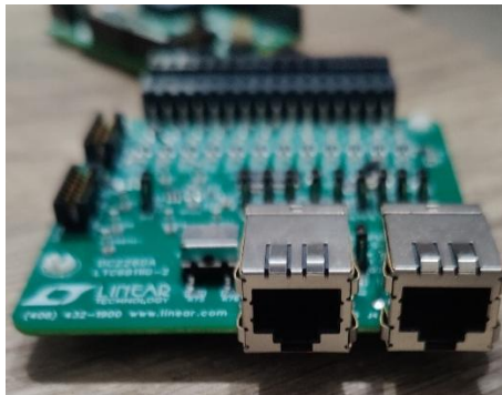
Ilustración 62: Puertos Ethernet RJ45
