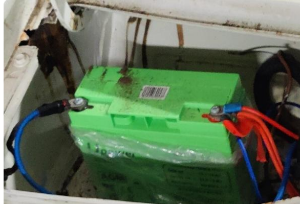
Ilustración 80: Batería auxiliar para el encendido del coche
