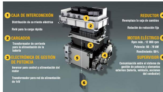
Ilustración 19: Componentes del motor eléctrico. Fuente: Forococheeléctricos
