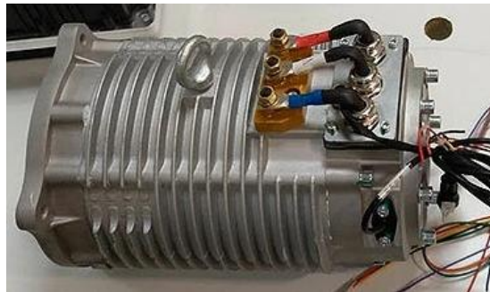
Ilustración 38: Motor AC HPQ7.5 72V
