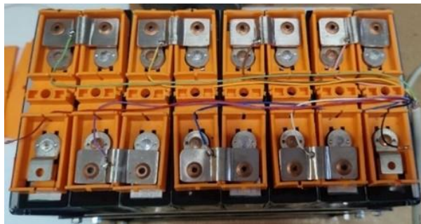
Ilustración 44: Conexión interna entre celdas
