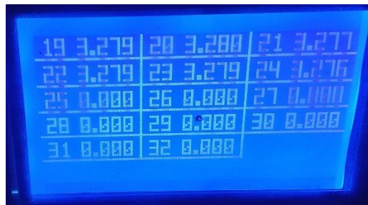
Ilustración 72: Captura de la pantalla en modo voltaje por celda 2
