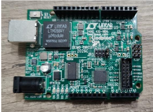
Ilustración 60: Foto de la placa Linduino One
