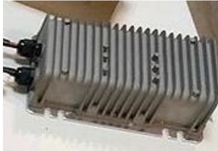
Ilustración 42: Conversor DC-DC 72/12V-30A
