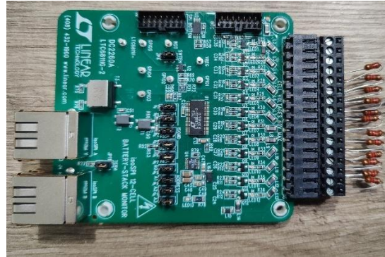
Ilustración 61: Foto de la placa DC2260A (LTC6811G-2)
