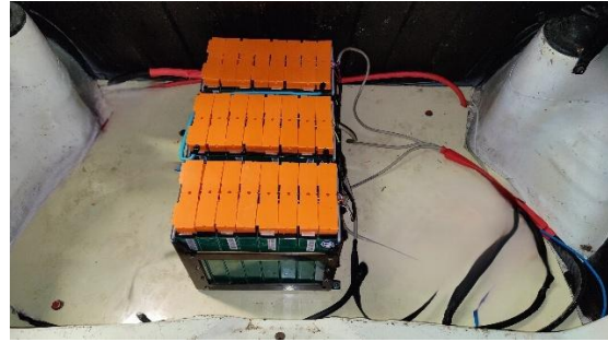
Ilustración 46: Foto de los módulos ubicados en el maletero
