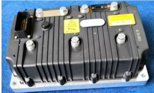
Ilustración 41: Controlador AC de 72V 400A
