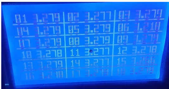
Ilustración 71: Captura de la pantalla en modo voltaje por celda 1
