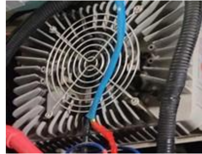
Ilustración 30: Cargador instalado en el coche eléctrico
