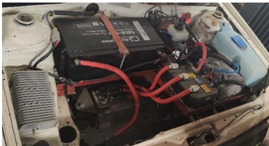
Ilustración 77: Ubicación de 2 baterías (junto al motor)
