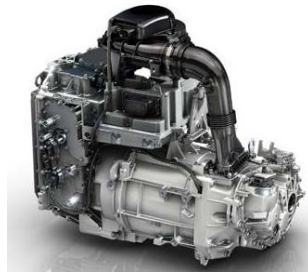
Ilustración 24: Motor asíncrono Renault Twizy(65 KW y 220 Nm). Fuente: movilidadelectrica
