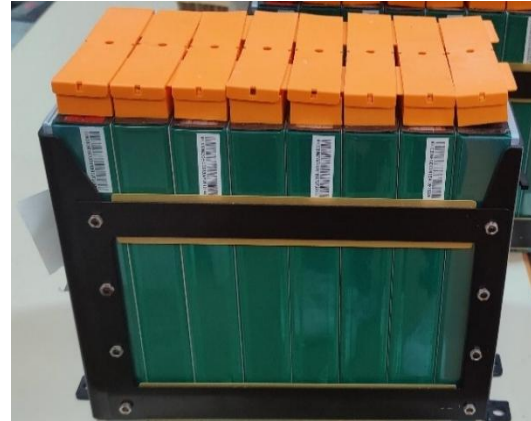
Ilustración 76: Batería de ferrofosfato y litio
