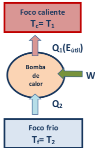
Figura 11 | Ciclo termodinámico de una bomba de calor.
