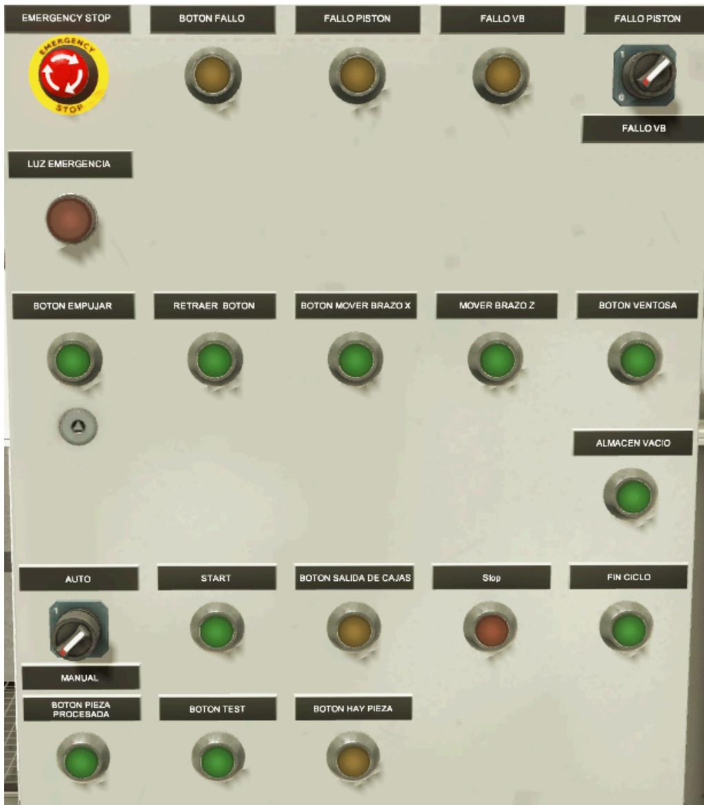
Figura 96. Pupitre de control diseñado en Factory IO para la estación 0.
