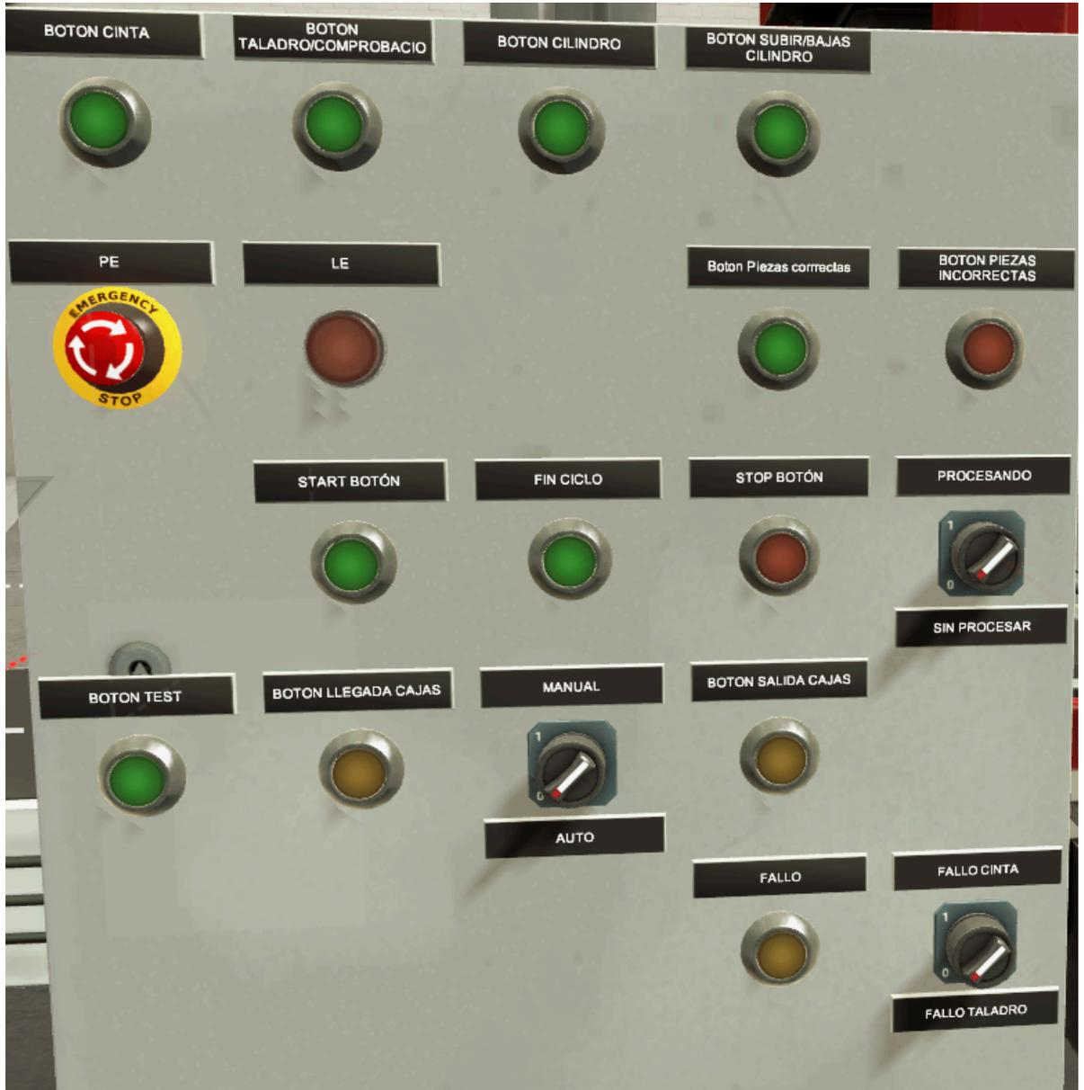
Figura 101. Pupitre de control creado en Factory IO para la estación 2.
