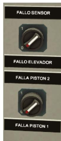
Figura 98. Selectores creados en Factory IO para escoger el tipo de fallo en la estación 1.
