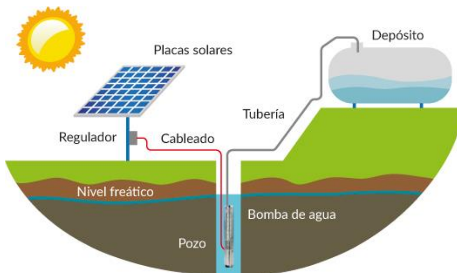
Figura 1. Esquema de funcionamiento sistema de bomba solar.
