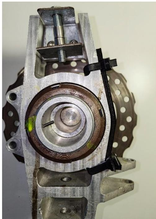
Figura 65. Instalación del conducto en la mangueta (2).
