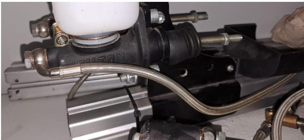
Figura 7. Latiguillos hidráulicos del vehículo.
