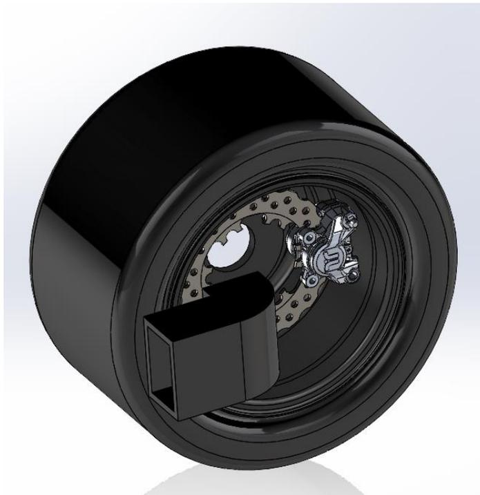
Figura 35. Ensamblaje con el conducto de refrigeración de prueba.
