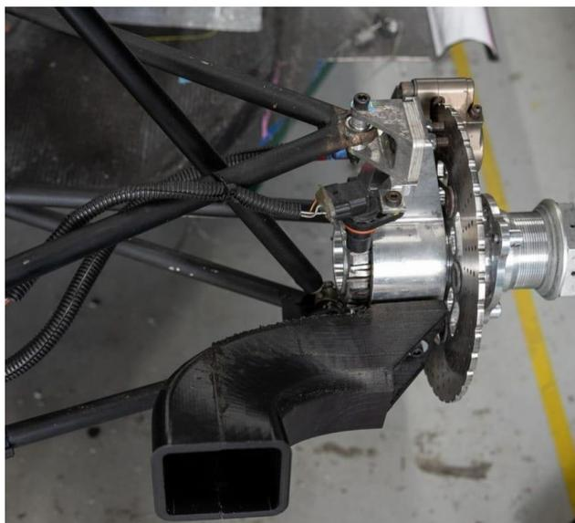
Figura 42. Conducto de freno de un equipo de Formula SAE Japan.
