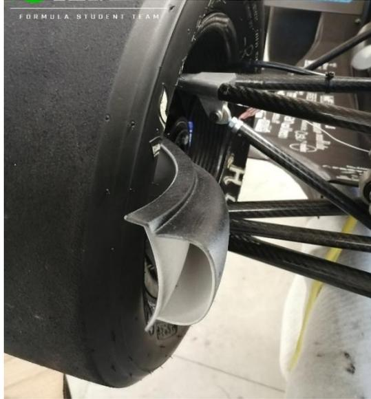
Figura 43. Conducto de freno del equipo e-Tech Racing.
