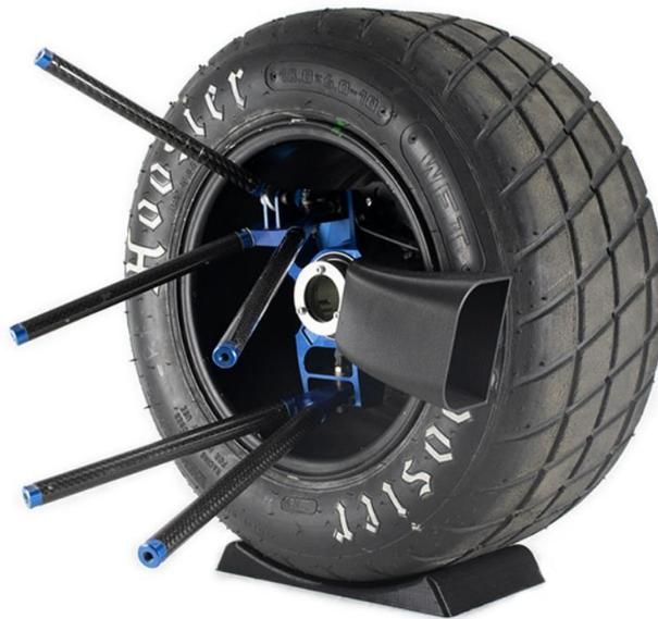
Figura 44. Conducto de freno del equipo BCN eMotorsport.
