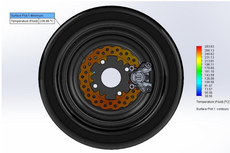
Figura 36. Temperatura mínima final tras un proceso de enfriamiento de 30 segundos.
