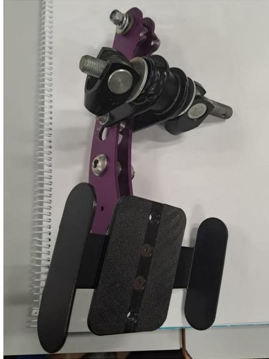
Figura 5. Pedal de freno y repartidor de frenada del vehículo.
