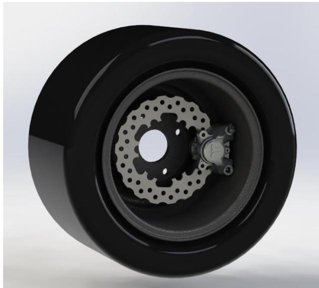
Figura 28. Ensamblaje para simulación del enfriamiento del disco.
