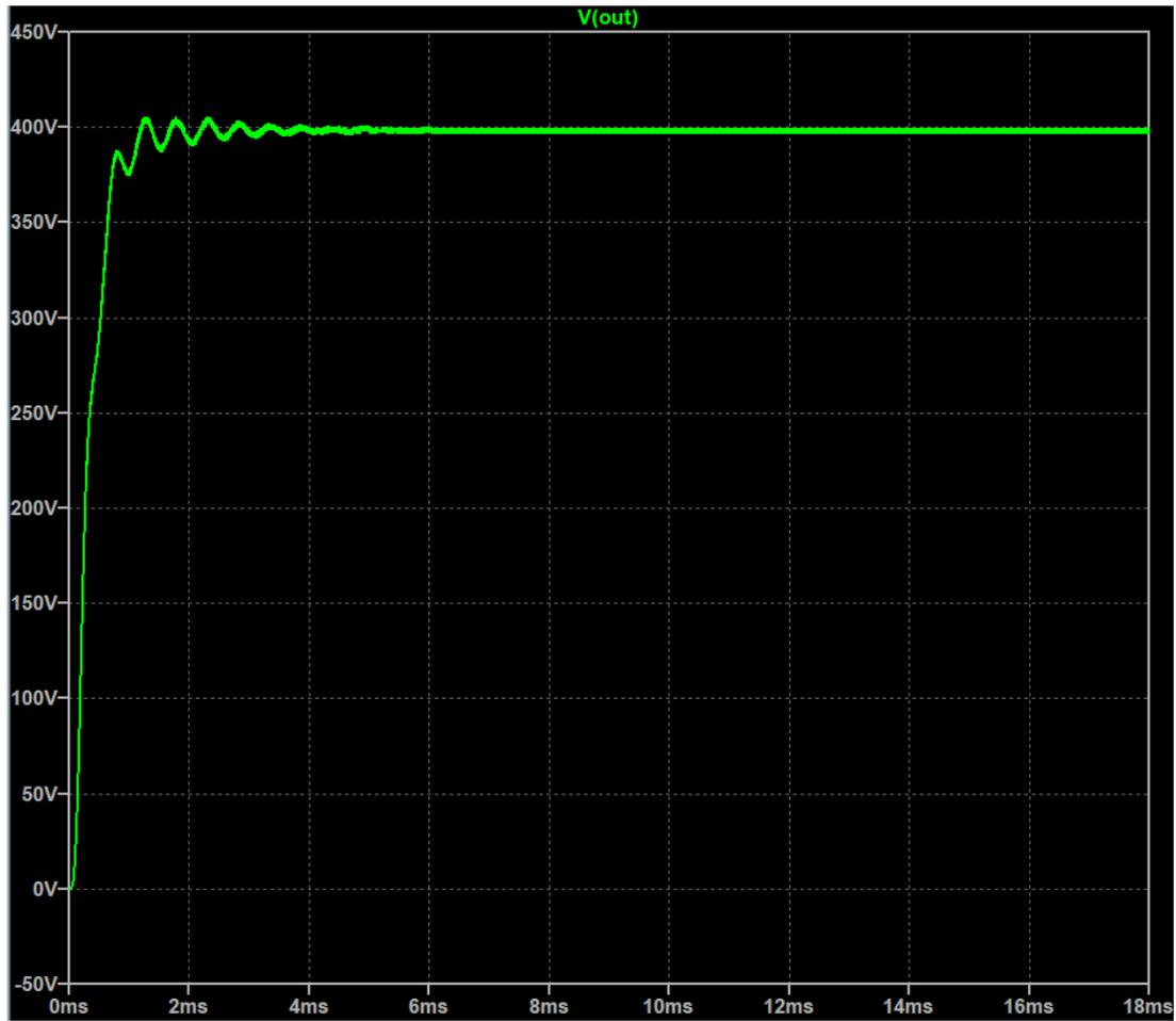
Fig. 4.3: Señal de tensión de salida del conversor Flyback.
