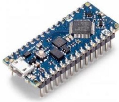
*Fig. 4.5: Arduino Nano Every escogido para implementar el algoritmo MPPT*
