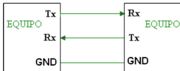
Figura 33. Líneas de comunicación serial
