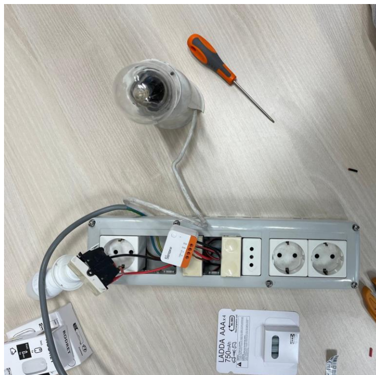
Figura 11. Montaje del conmutador junto con los dos interruptores y la bombilla que controla (arriba a la izquierda).
