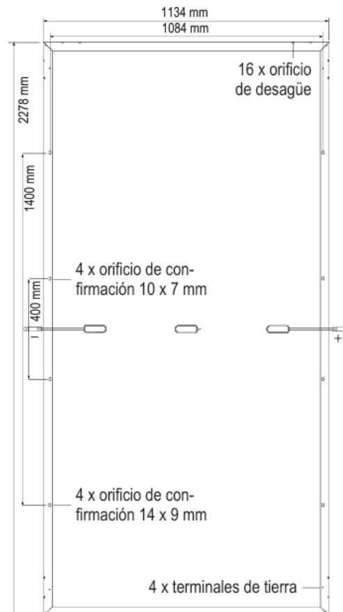
Ilustración 7.3. Medidas del módulo fotovoltaico seleccionado
