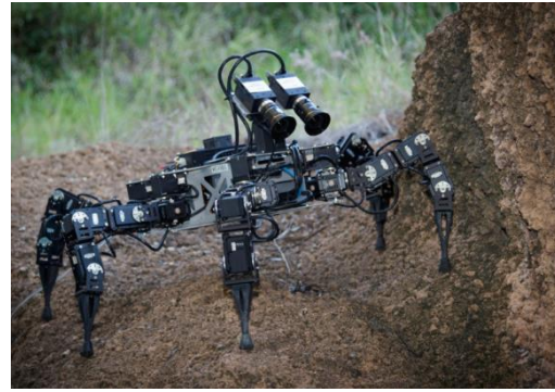
Figura 2. Robot hexápodo para ubicaciones remotas y entornos hostiles. Fuente: [5]
