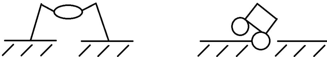
Figura 31. Izquierda: Estabilidad de un robot hexápodo en terreno irregular. Derecha: Inestabilidad de un robot con ruedas en terreno irregular. Fuente: Elaboración propia.
