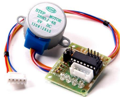
Figura 67. Motor paso a paso 28BYJ-48 (opción descartada para el proyecto). Fuente: [40]
