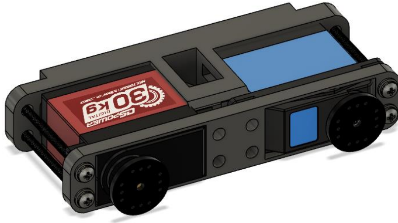
Figura 36. Fémur con servomotores ensamblado. Fuente: Elaboración propia.
