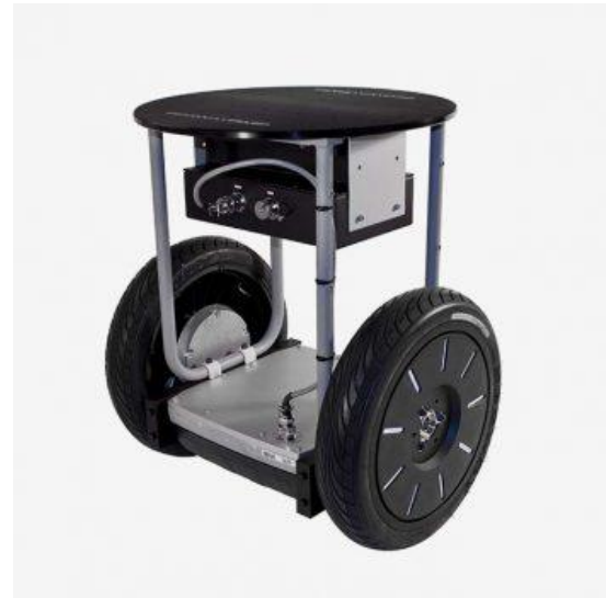
Figura 25. Ejemplo de robot dinámicamente estable. Segway RMP. Fuente: [25]
