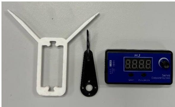
Figura 71. De izquierda derecha: Pieza impresa en 3D (base superior del servomotor) blanca, pieza impresa en 3D (aguja) negra y Servo Tester HJ. Fuente: Elaboración propia.
