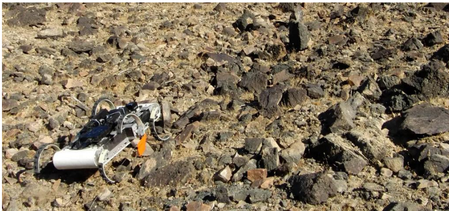
Figura 8. RHex subiendo una colina rocosa y empinada en medio del desierto. Fuente: [7]
