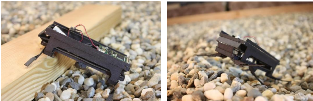
Figura 13. Izquierda: DASH trepando un obstáculo más alto que él. Derecha: DASH caminando a través de rocas. Fuente: [9]
