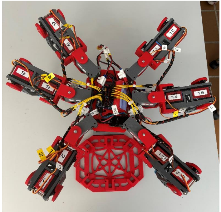
Figura 91. Cableado terminado y vista del robot desde arriba.
