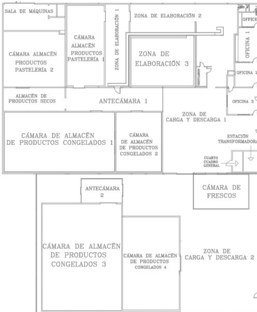
Ilustración 3. Distribución de la planta
