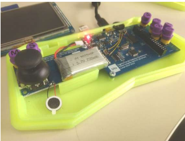
Figura 14. Vista interior de la videoconsola v2.0. Se tuvo que cambiar de módulo TFT ya que el empleado el año anterior se dejó de vender. Encontramos uno compatible en software.
