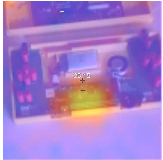
Figura 3. Uso de la cámara termográfica. Se observa que las zonas donde se encuentran los reguladores de tensión y el cargador de batería están más templadas.
