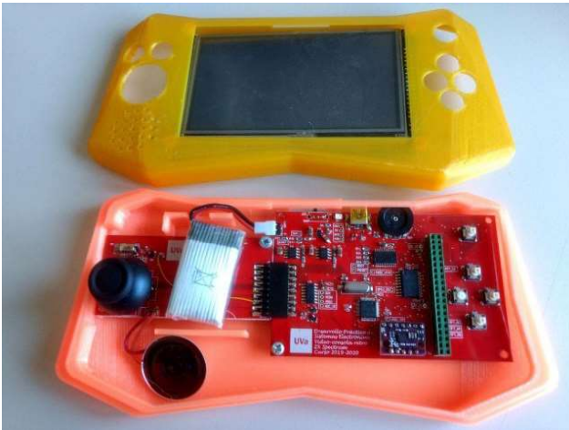
Figura 19. Vista interior de la videoconsola v3.0. Incorpora un vibrador -arriba a la izquierda- y un acelerómetro-giroscopio -abajo a la derecha- a mayores.
