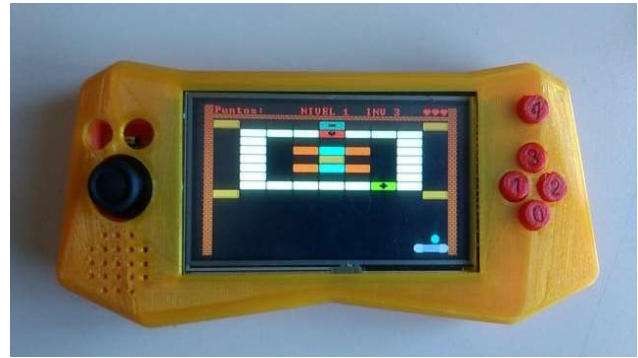
Figura 20. Ejemplo de videojuego Arkanoid desarrollado por los alumnos en modo nativo sin emplear el emulador.
