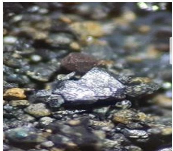
Figura 10. Presencia de magnetita y hematita pseudomagnetita.
