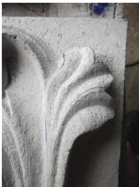
Figuras 31.- Detalle, conjunto de hojas exteriores, encajadas y modeladas con gradina.
