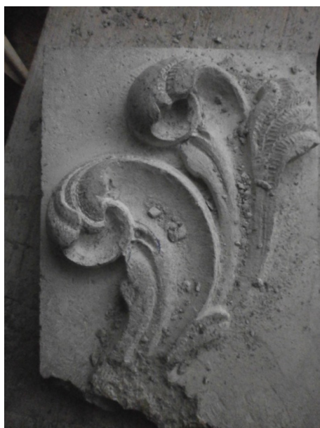
Figuras 29.- Profundizado de los nervios de las hojas y ahuecados de las cabezas.
