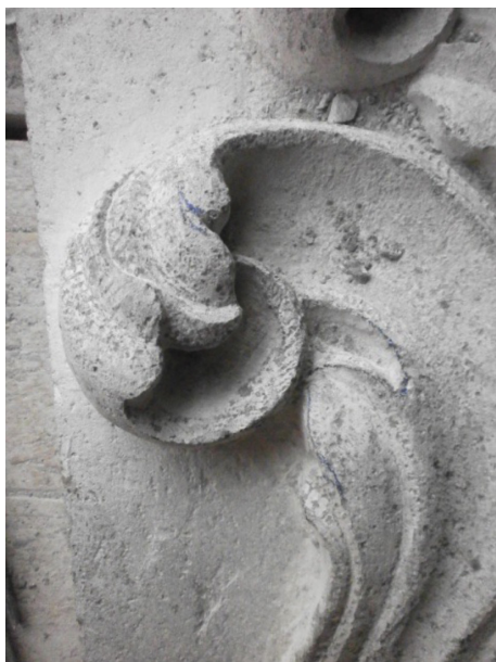
Figuras 35.- Encajado, modelado y definición del conjunto de hojas.
