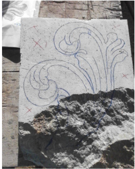
Figuras 23.- Superficie con marcas en cruz de color rojo del material a eliminar.
