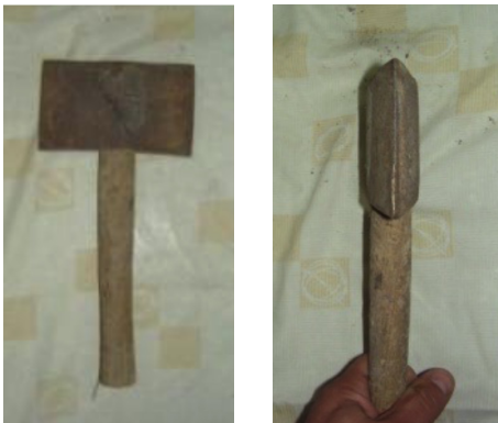
Figura 18 y 19.- Escoda. Vistas de perfil y alzado.
