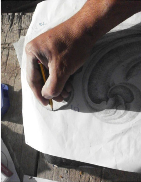
Figuras 21.- Transferencia del dibujo a la piedra.
