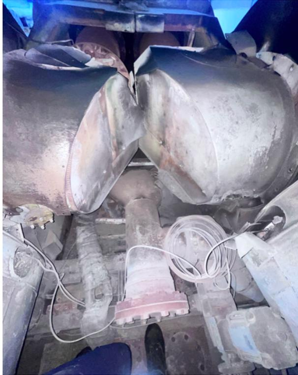
**Figura 4.20:** Waste Gate anulada y sin by-pass
