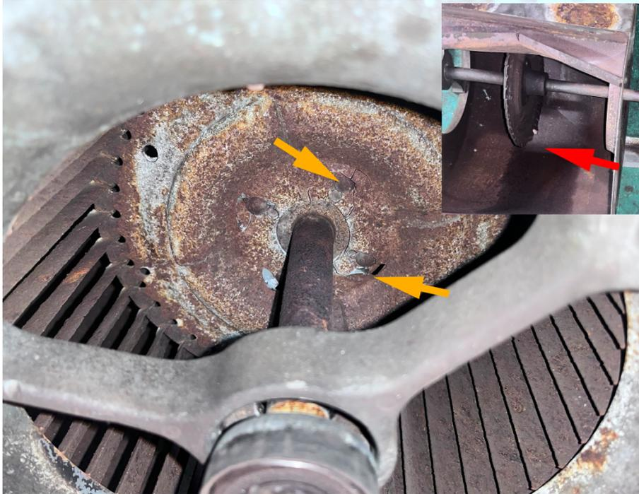
**Figura 4.4:** Ventilador agrietado y sin aletas
