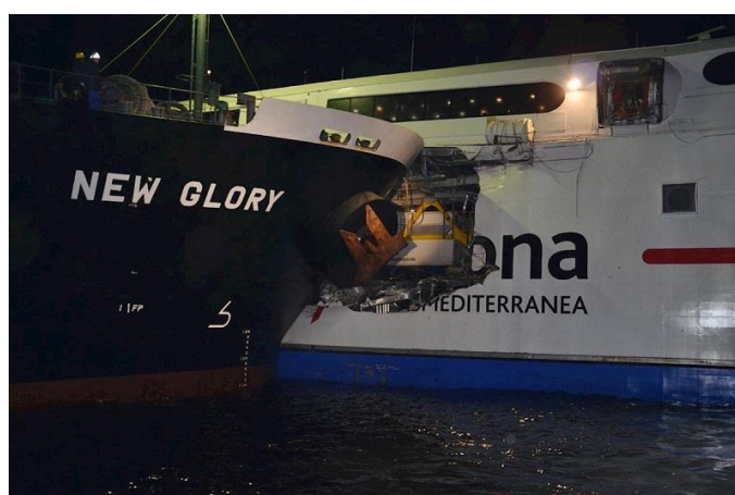
Ilustración 12. Resultado de la colisión entre el “New Glory” y el “Milenium Dos”
