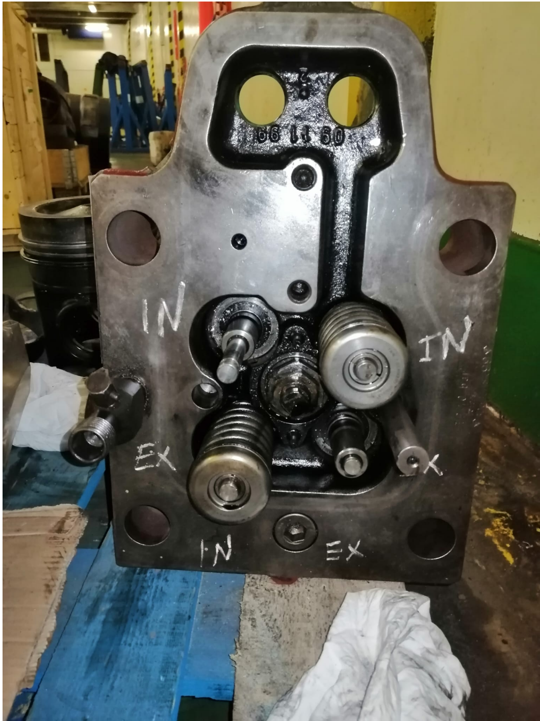
Figura A.1: Posición de las válvulas en la culata dañada Fuente: Colección propia
