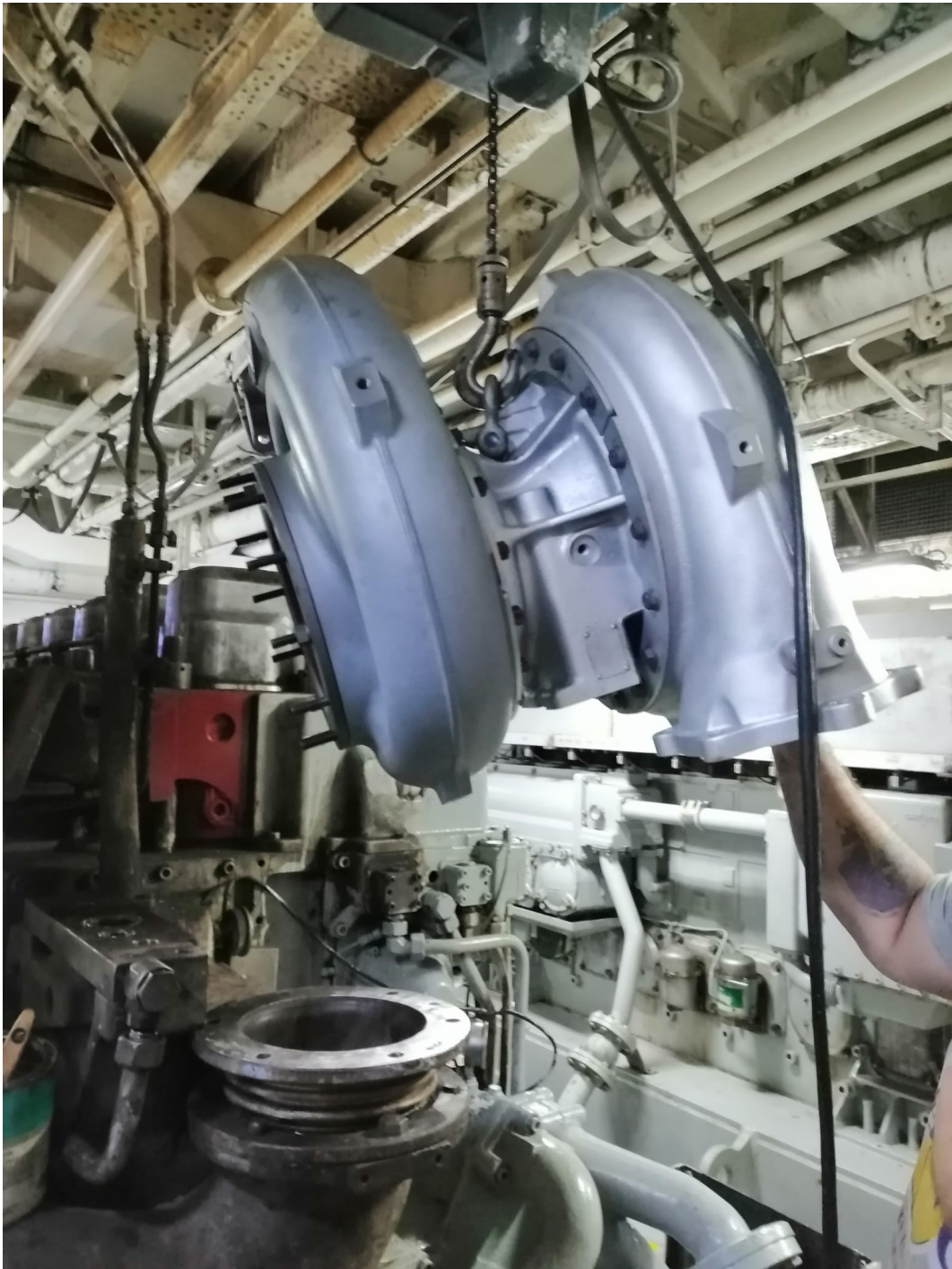
Figura A.6: Colocando la turbo nueva en el motor Fuente: Colección propia
