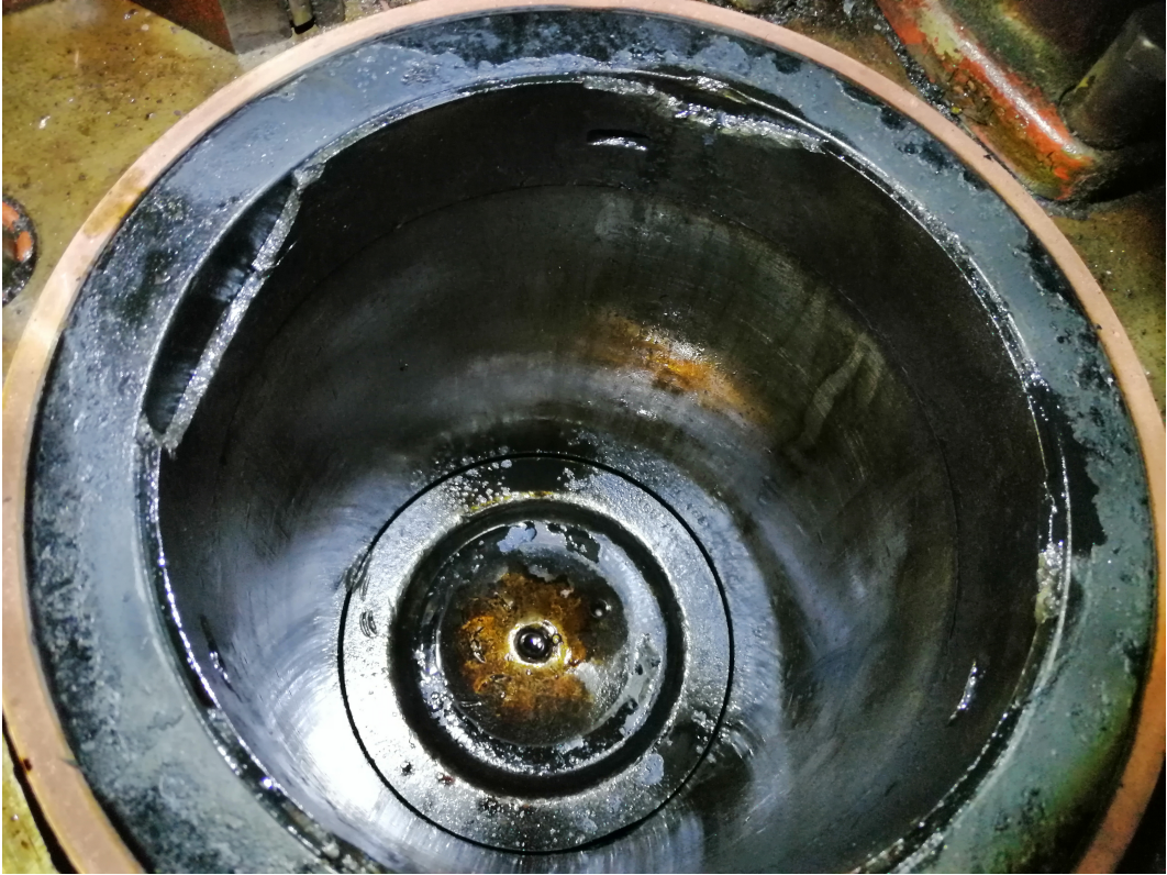
Figura 1.3: Camisa dañada del cil. N o 9 del motor aux. N o 2 Fuente: Colección propia
