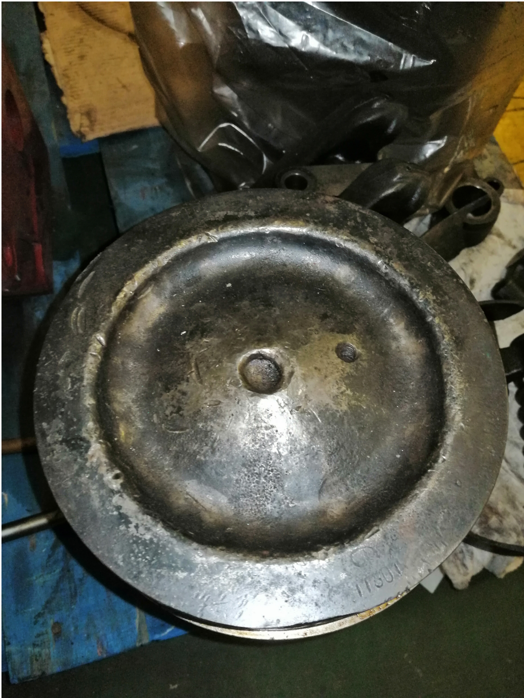
Figura A.2: Marcas en la cabeza del pistón causadas por el golpeteo de las válvulas Fuente: Colección propia
