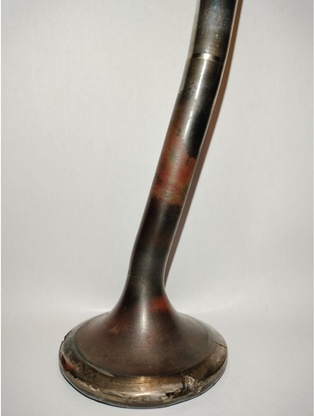
Figura 4.6: Deformación de la válvula. Fuente: Colección propia
