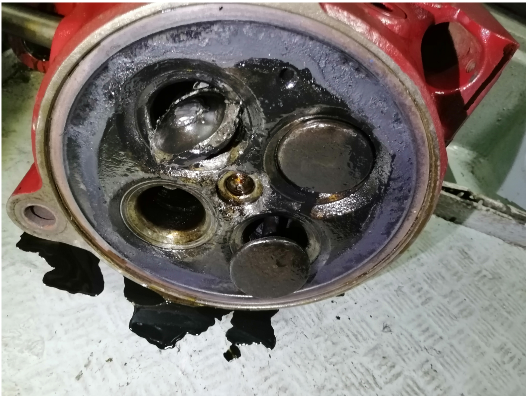
Figura 1.2: Culata N°9 del motor auxiliar N°2 dañada Fuente: Colección propia
