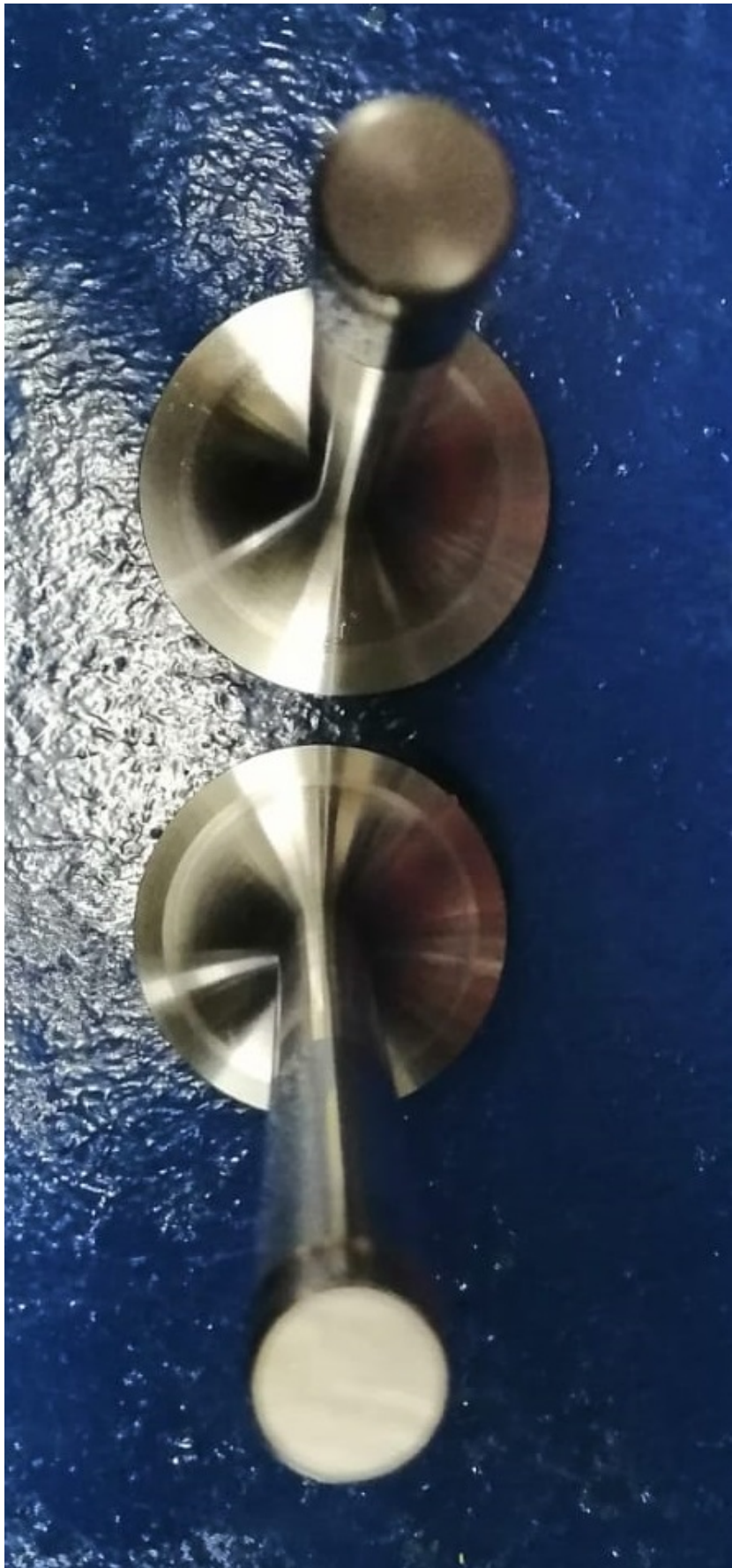
Figura 3.4: Diferencia de tamaños entre las válvulas Fuente: Colección propia
