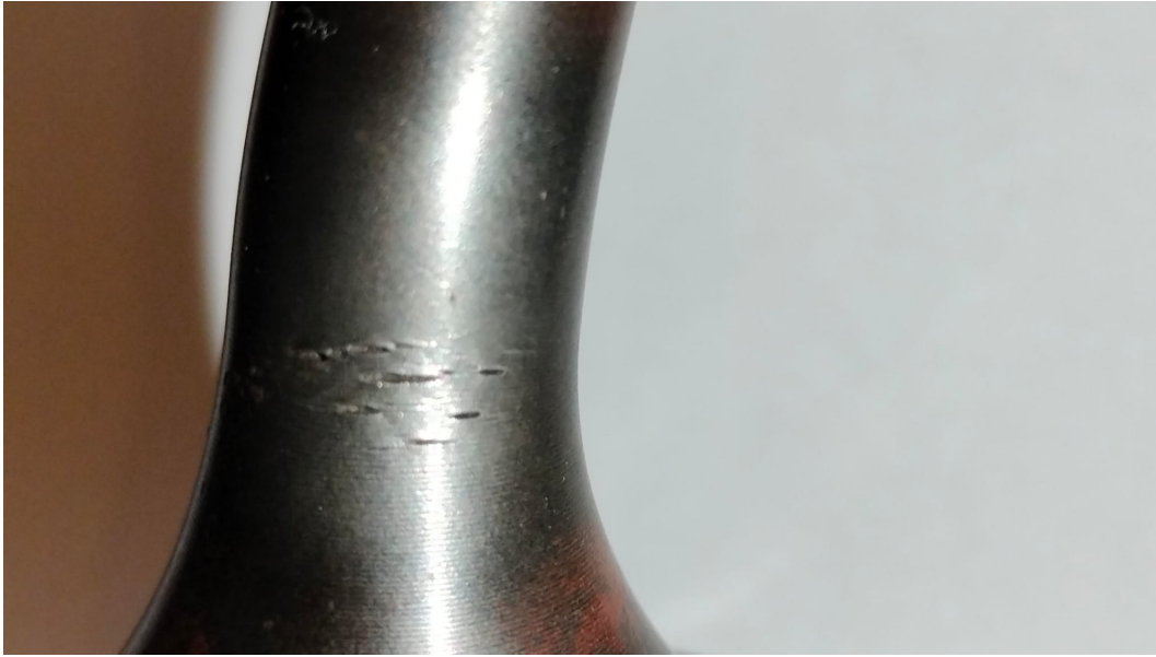
Figura 4.4: Daños en la válvula Fuente: Colección propia
