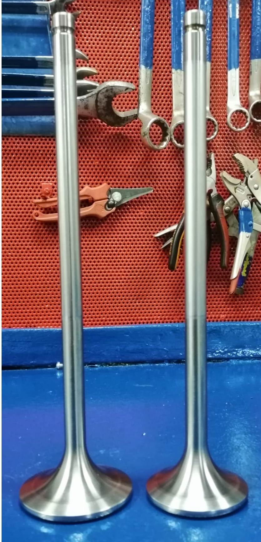
Figura 3.1: Válvulas de admisión y de escape sin dañar Fuente: Colección propia
