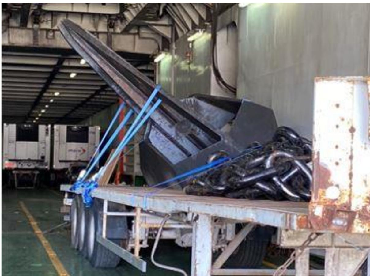
*Ilustración 71. Ancla trincada con cinchas. Elaboración propia.*
