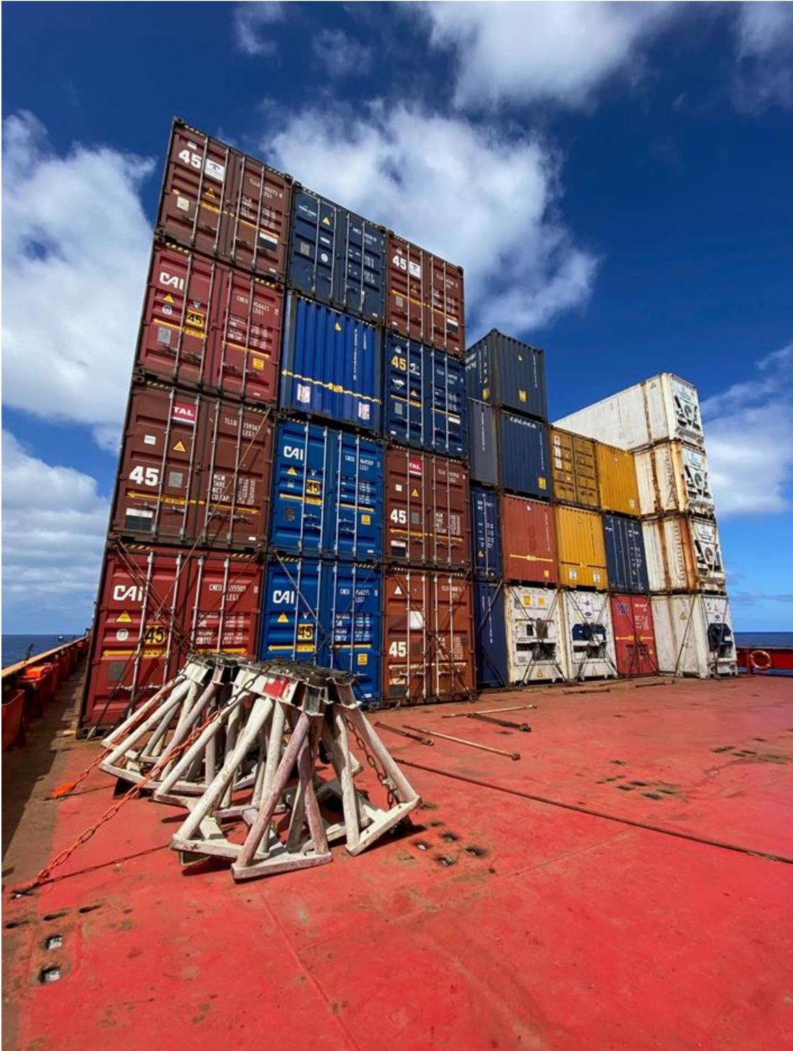
*Ilustración 54. Contenedores trincados en el Canarias Express. Elaboración propia.*
