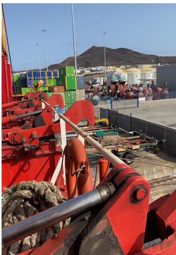
**Ilustración 20.** Trincas de la rampa en cubierta de contenedores. *Elaboración propia.*
