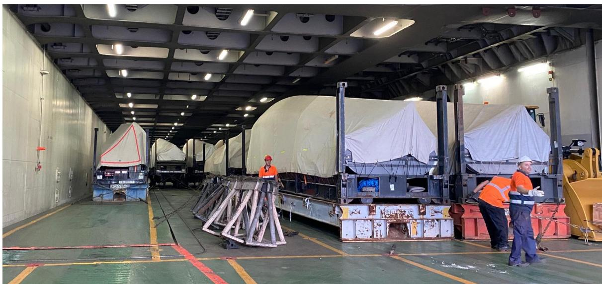
*Ilustración 55. Mercancía sobre roll trailers trincada con cadenas. Elaboración propia.*
