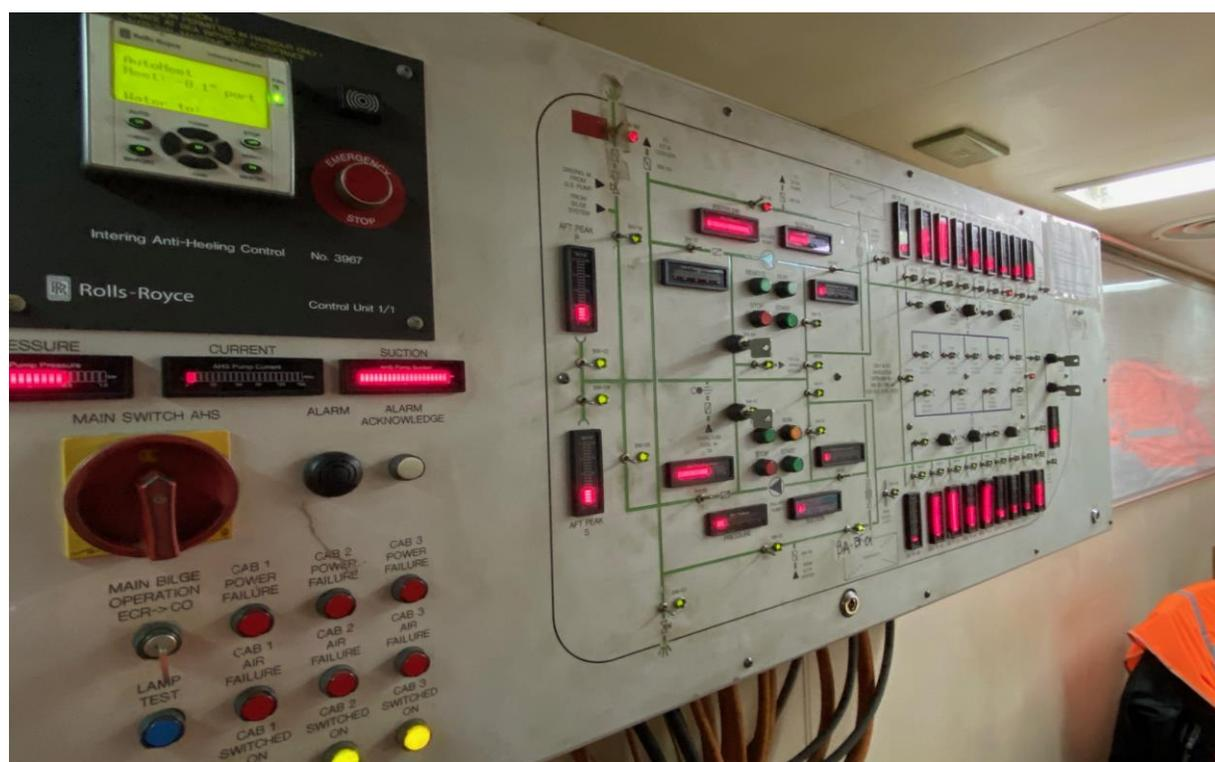
Ilustración 30. Centro de control de lastre en la oficina de carga. Elaboración propia.
