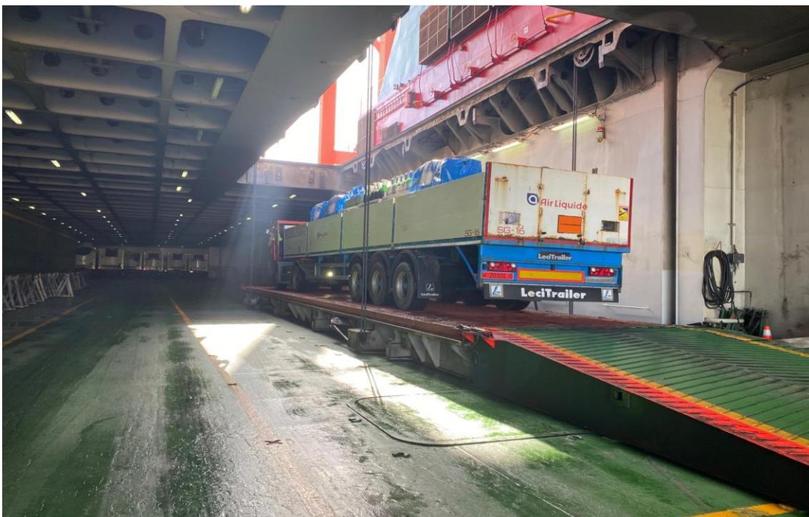
Ilustración 25. Remolque con mercancía IMDG para subir a cubierta de contenedores. Elaboración propia.
