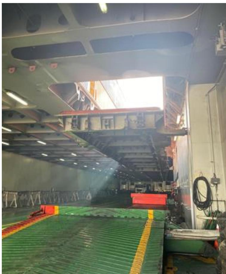
**Ilustración 24.** Lengüetas levantadas. *Elaboración propia.*
