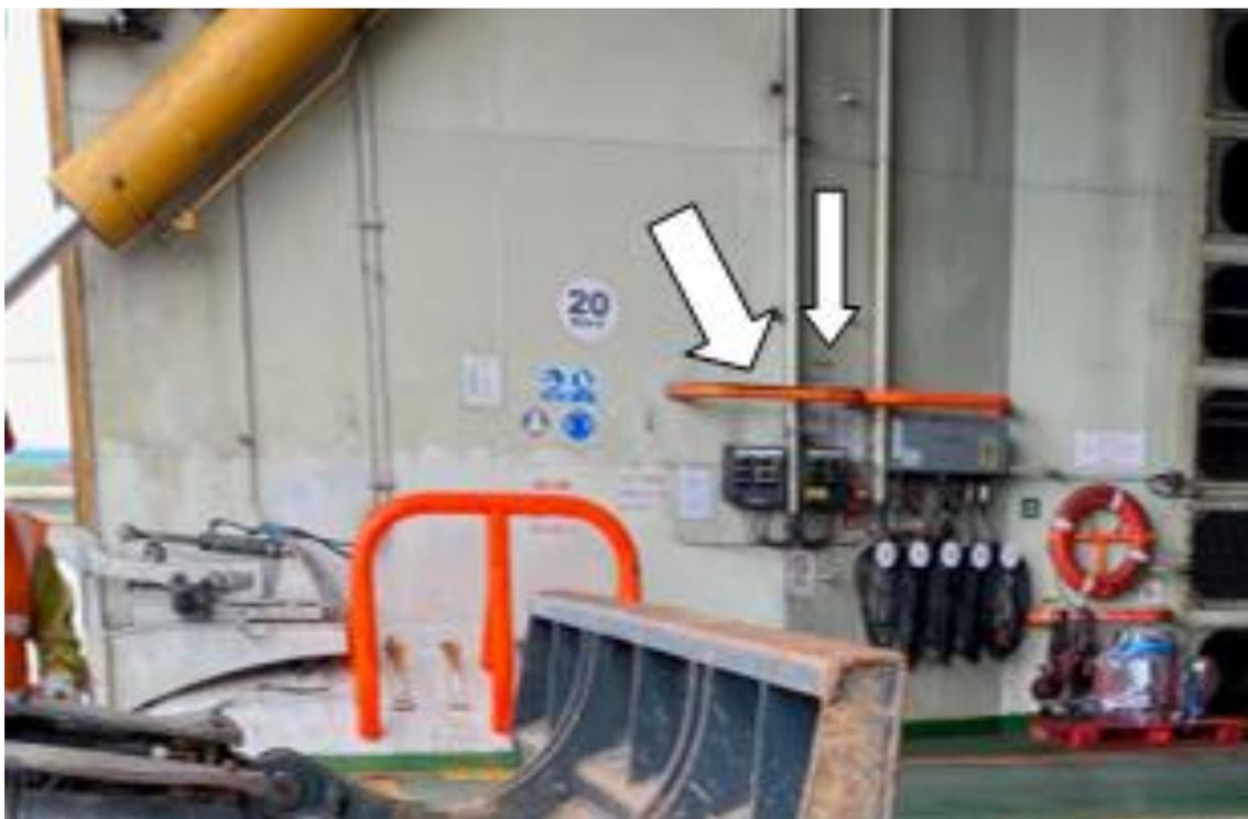
**Ilustración 19.** Posición cajas de controles. Flecha ancha de rampa. Flecha fina de tapa de bodeguín.
