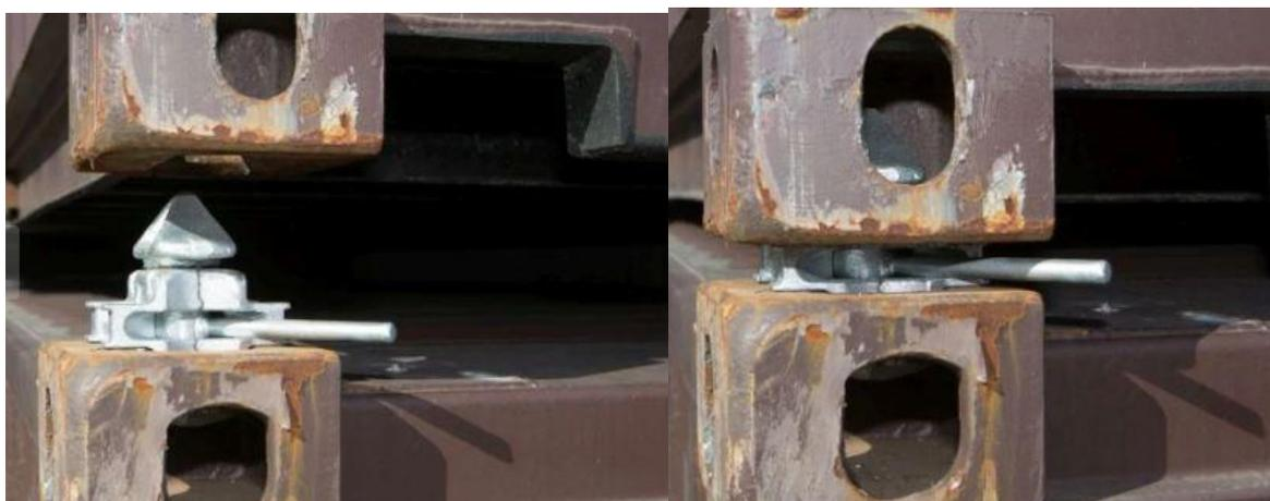
**Ilustración 57.** Twistlock. Fuente: [braun-container.de](http://braun-container.de).
