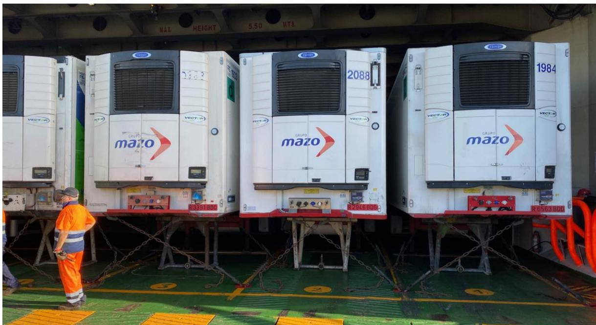
Ilustración 77. Remolques trincados. Elaboración propia.
