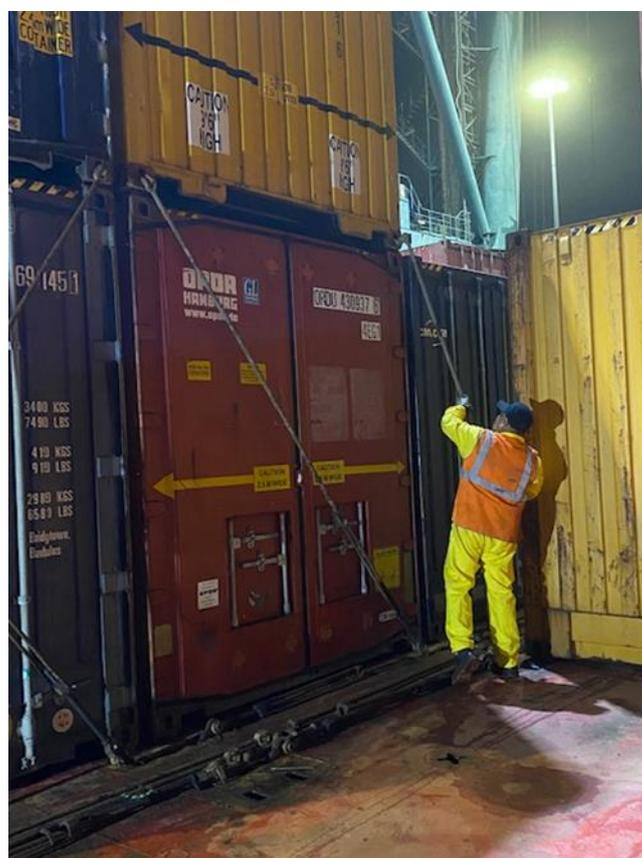
Ilustración 53. Trincaje durante la carga. Elaboración propia.
