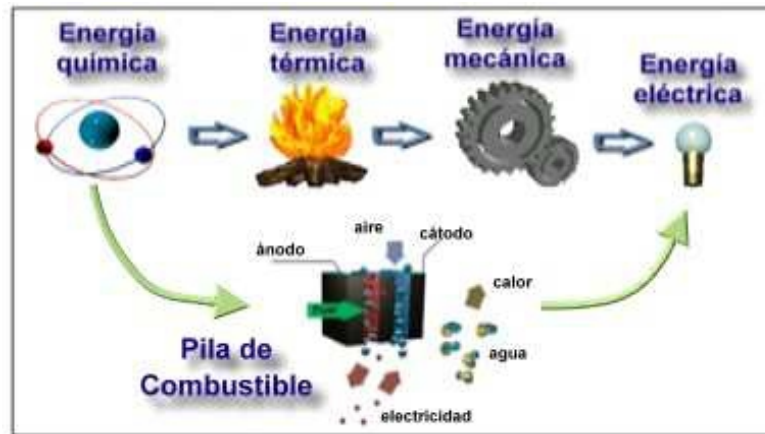
Fig. 1.2. Etapas de la transformación de energía química en energía eléctrica por medio de los procesos tradicionales y por medio de una pila de combustible.
