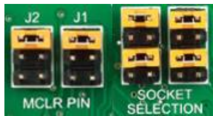
Figura 2.3: Jumper mikroProg J2 y J1 (Manual del fabricante)
