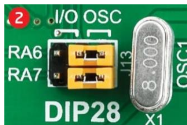
Figura 2.5: Jumper J13 (Manual del fabricante)
