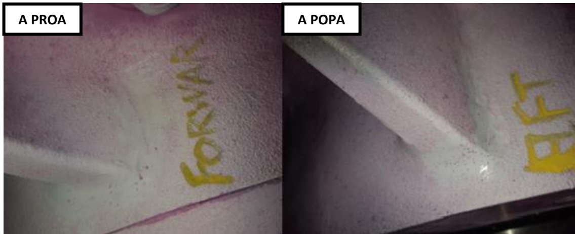
Ilustración nº56. Líquidos penetrantes después de haberlo pulido
