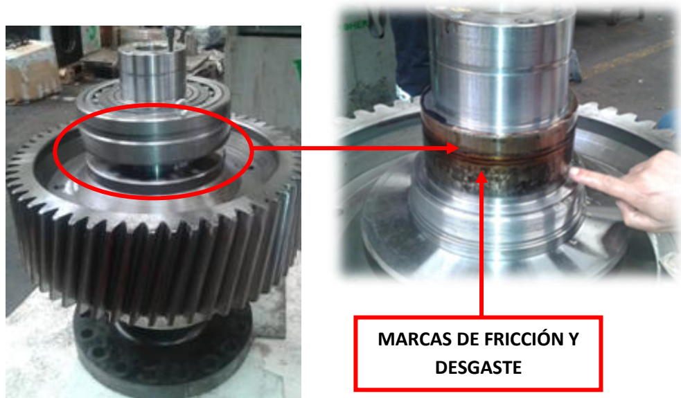
Ilustración nº73. Despegue del rodamiento
