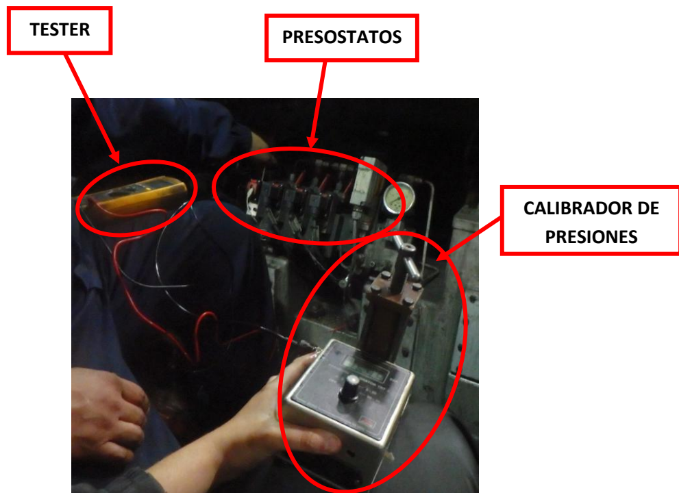
Ilustración n°43. Comprobación de los presostatos
