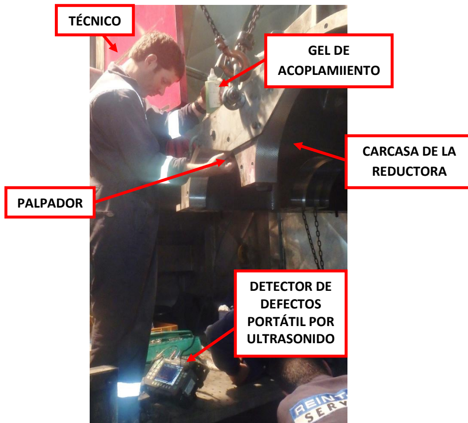
Ilustración n°59. Técnico realizando prueba de ultrasonido
