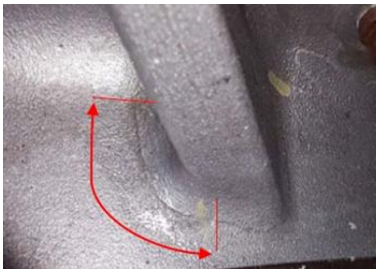
Ilustración nº49. Grieta a proa de la reductora
