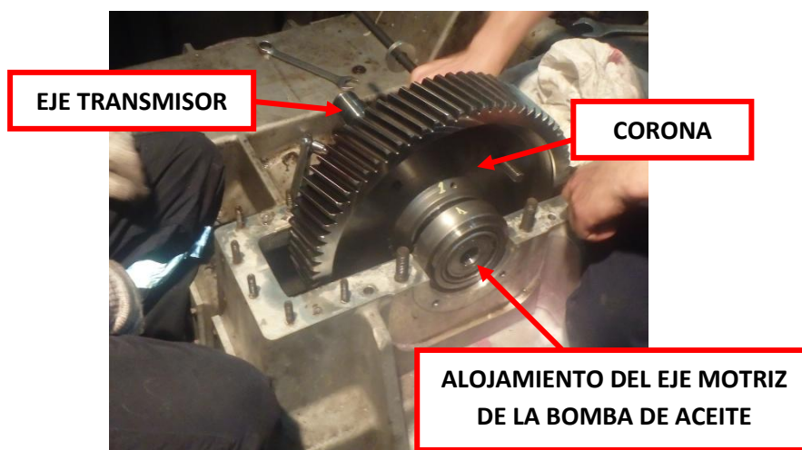
Ilustración nº65. Corona principal del sistema de engranajes de la PTO
