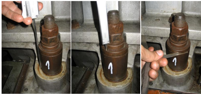
Ilustración nº39. Comprobación de los pernos de ajuste flexible
