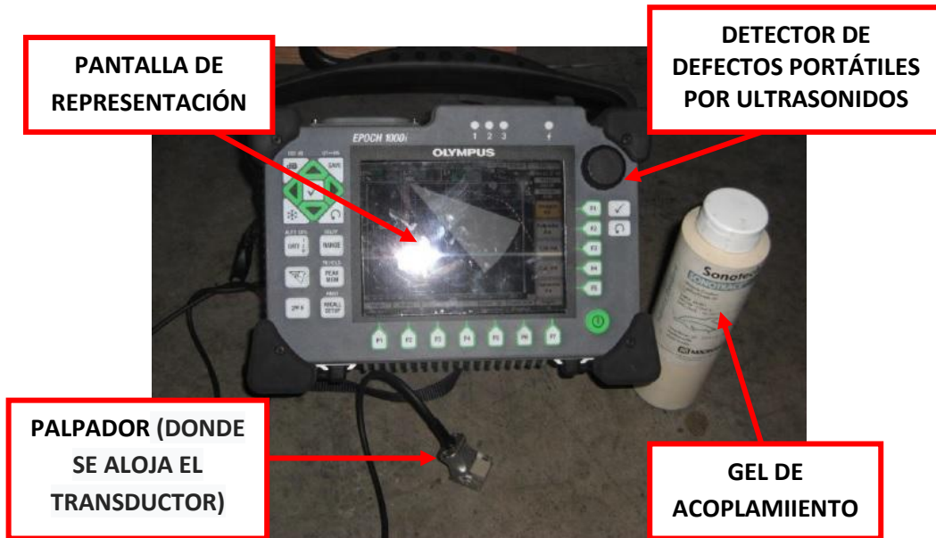
Ilustración n°58. Conjunto del equipo utilizado en la prueba “Olympus Epoch 1000i”
