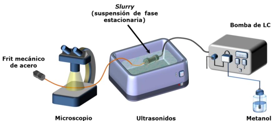
Figura I.14. Esquema del sistema utilizado para llevar a cabo el empaquetamiento de capilares mediante el método de slurry .
